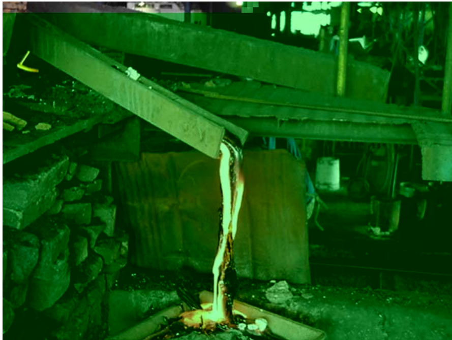
Figura 2.5 - Vazamento de escória líquida em um forno tipo cubilô.
