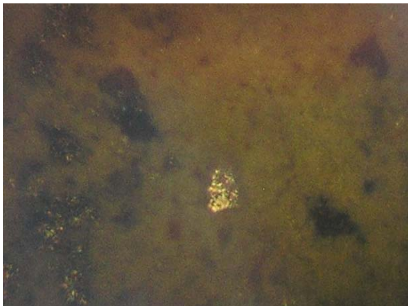
Figura 5.9 – Microscopia óptica da amostra de argamassa produzida com escória/granito. Aumento 50 vezes.
