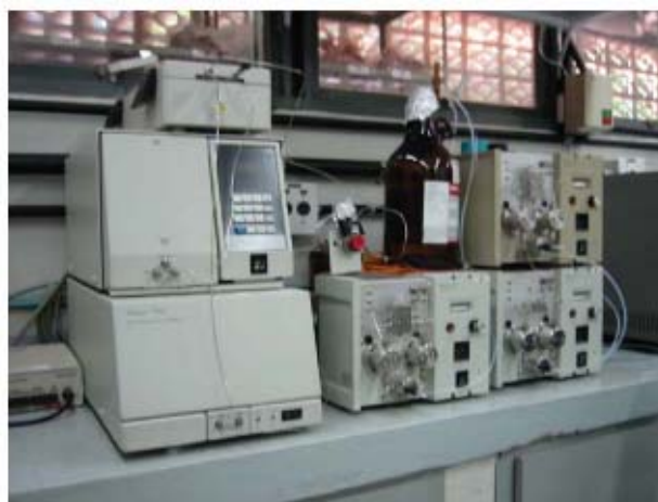
Figura 45 - Equipamento para cromatografia de permeação em gel (GPC) Waters, modelo 717 utilizado neste trabalho. O equipamento pertence à Petroquímica União/ SP.
