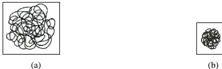
Figura 28 - Representação esquemática de um polímero do tipo novelo aleatório em bom solvente (a) e em mau solvente (b).
