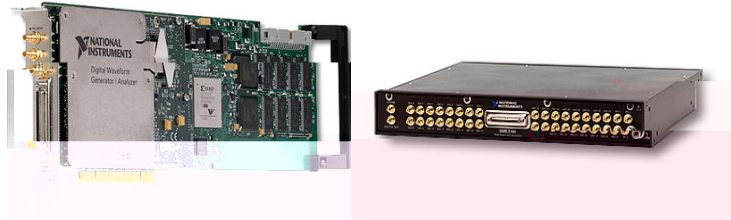
Figura 29 - Placa NI PCI-6541 e conjunto de conectores de distribuição dos canais do gerador/analisador digital
