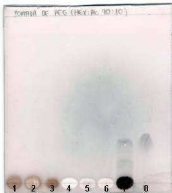
Figura 28: Cromatografia em camada delgada do padrão ácido caurenóico, extrato concentrado e das preparações semi-sólidas do tipo pomada de PEG após estabilidade acelerada. 1 e 2 – STS3A temperatura ambiente; 3 – STS3B temperatura ambiente; 4 – STS3A estufa t_{90} ; 5 – STS3B estufa t_{90} ; 6 – STS3A temperatura ambiente t_{90} ; 7 – extrato concentrado e 8 – ácido caurenóico (padrão).
