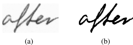
Figura 4.2: Exemplo da aplicação do algoritmo de Otsu para limiarização de imagens em nível de cinza, sendo que a Figura 4.2(b) é o resultado da aplicação deste método na Figura 4.2(a).
