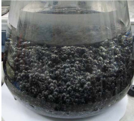
Figura 3.11 – Detalhe do desprendimento de bolhas durante o vácuo no ensaio DMM.
