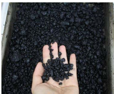
Figura 3.8 – Mistura asfáltica na condição solta.
