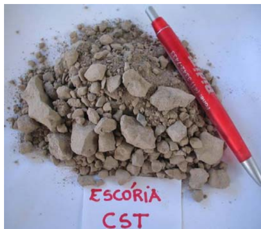
Figura 3.1 – Escória de aciaria utilizada neste estudo.
