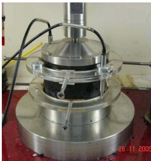
Figura 3.16 – Corpo-de-prova durante ensaio de creep estático na COPPE.
