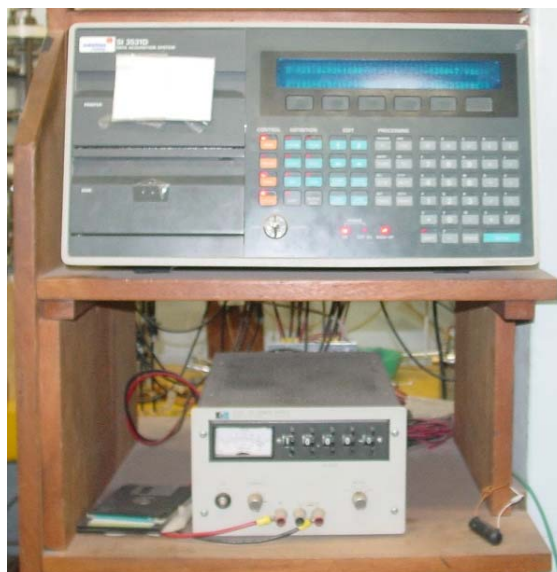
Figura A. 1 – Sistema de aquisição de dados e fonte de tensão.
