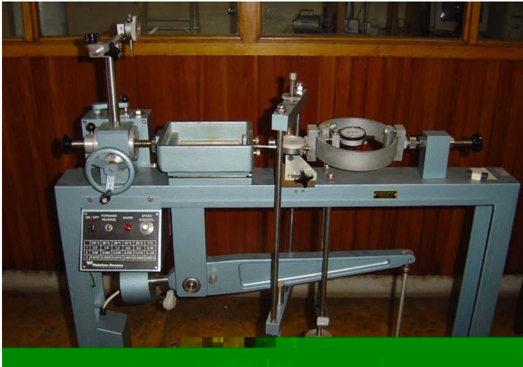
Figura 4.1 – Prensa de cisalhamento direto convencional do Laboratório de Geotecnia da EEUFMG.
