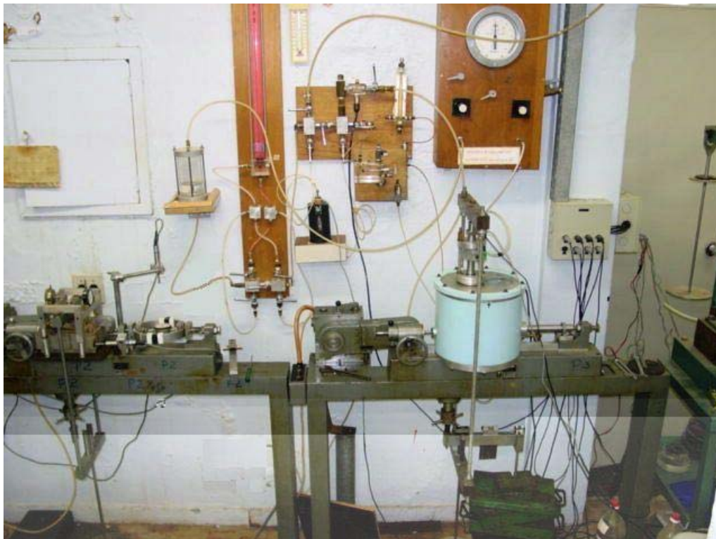
Figura 4.4 – Equipamento de cisalhamento direto com sucção controlada da PUC - Rio.
