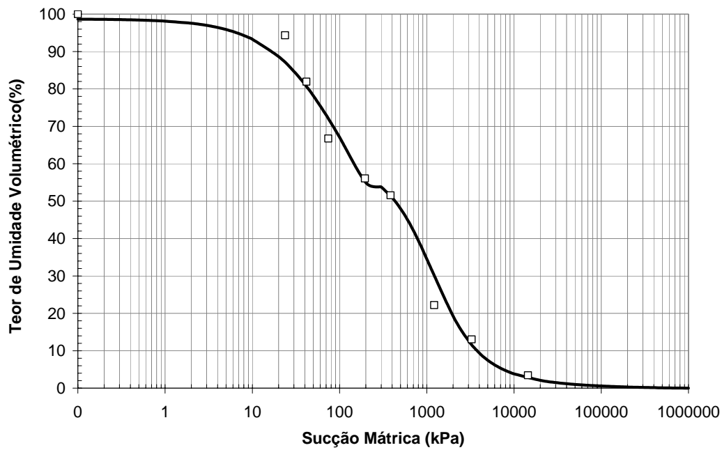
Figura 5.21 – Curva característica de sucção em função do grau de saturação - SR2.
