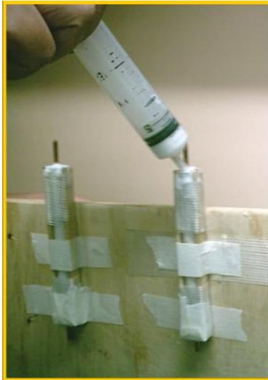
Figura 3.22 – Confecção dos corpos de prova
