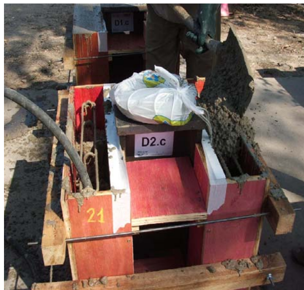
FIGURA 3.26 – Modelo para push-out concretado na vertical.
