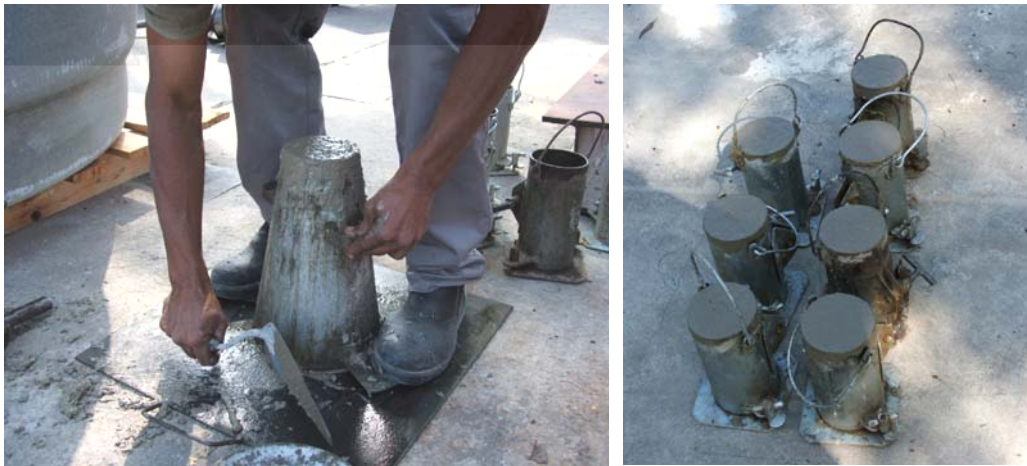
FIGURA 3.27 – Slump-test e cilindros para o controle tecnológico do concreto.
