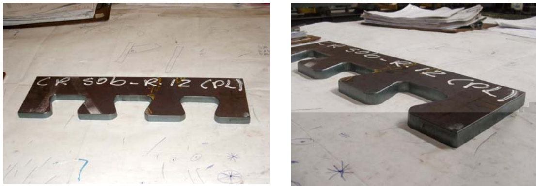
FIGURA 3.12 – Aspecto do conector em chapa dentada Crestbond-PL (OLIVEIRA et al. , 2006).
