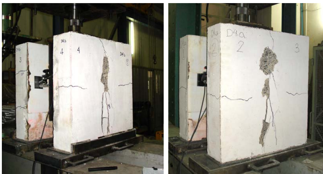
FIGURA 4.6 – (a) modelo com contenção lateral (b) modelo sem contenção lateral.
