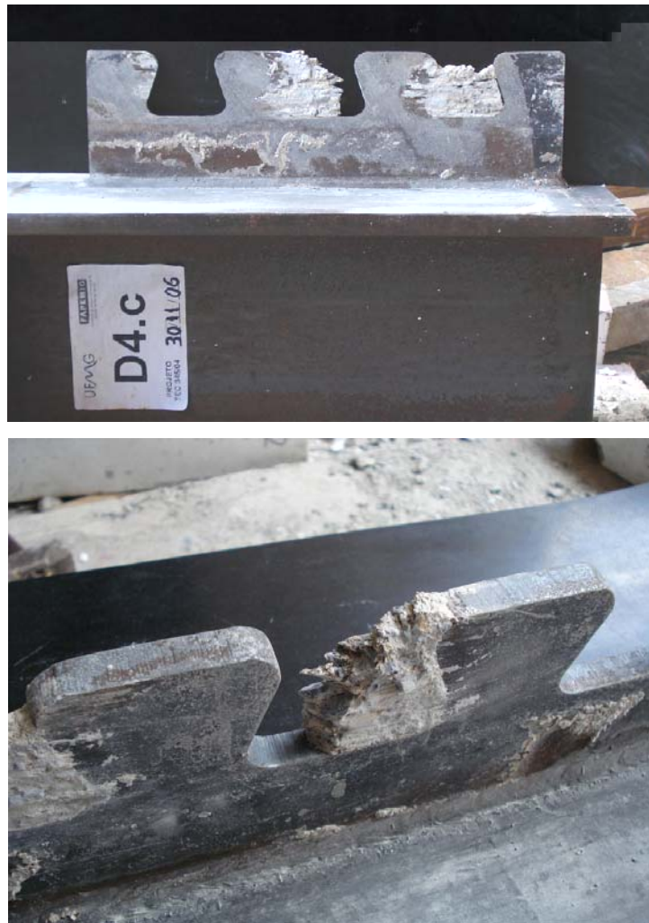
FIGURA 4.9 – Detalhe do concreto compactado no interior dos furos do conector, cisalhado em dois planos de corte.
