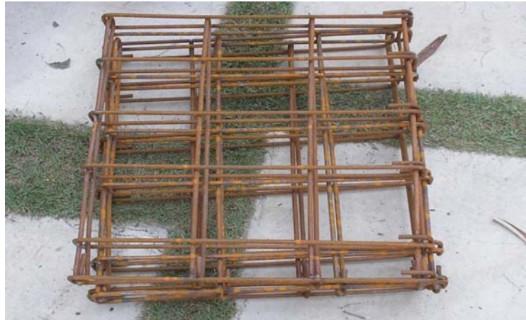
FIGURA 3.19 – Aspecto das armaduras dos modelos.
