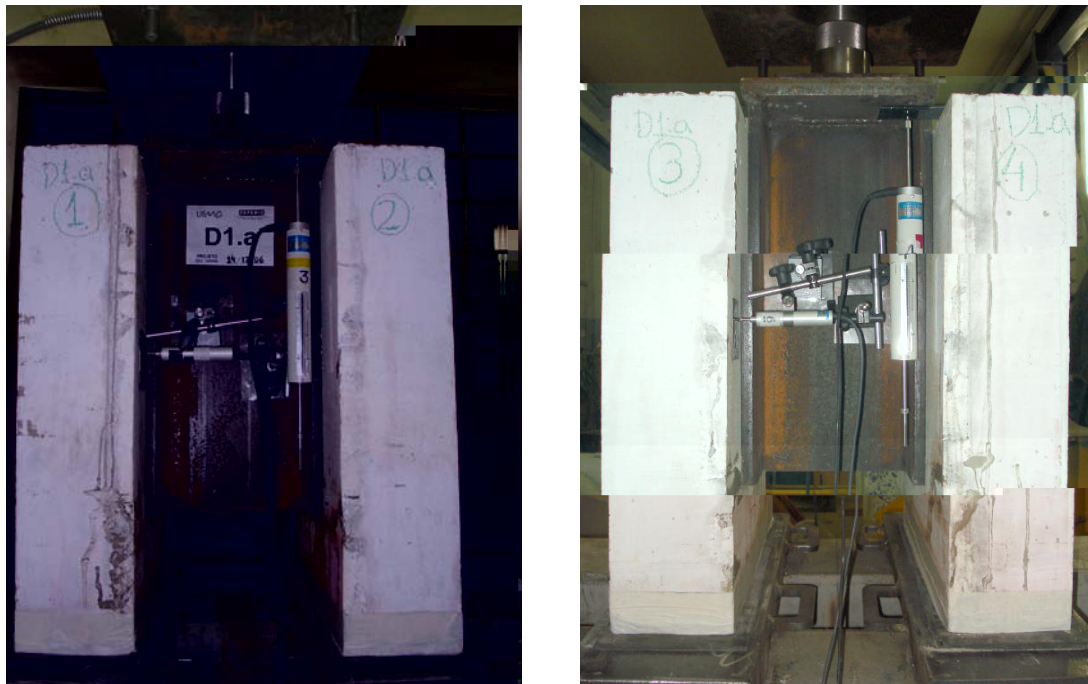
FIGURA 3.33 – Detalhes dos transdutores de deslocamento de 30 e 100 mm.
