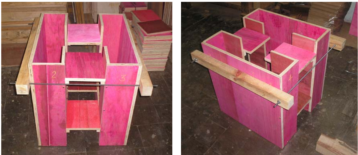
FIGURA 3.15 – Aspecto da fôrma para os modelos.
