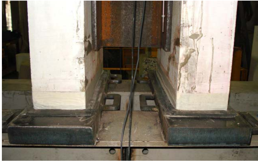
FIGURA 3.30 – Detalhe do neoprene abaixo do modelo.
