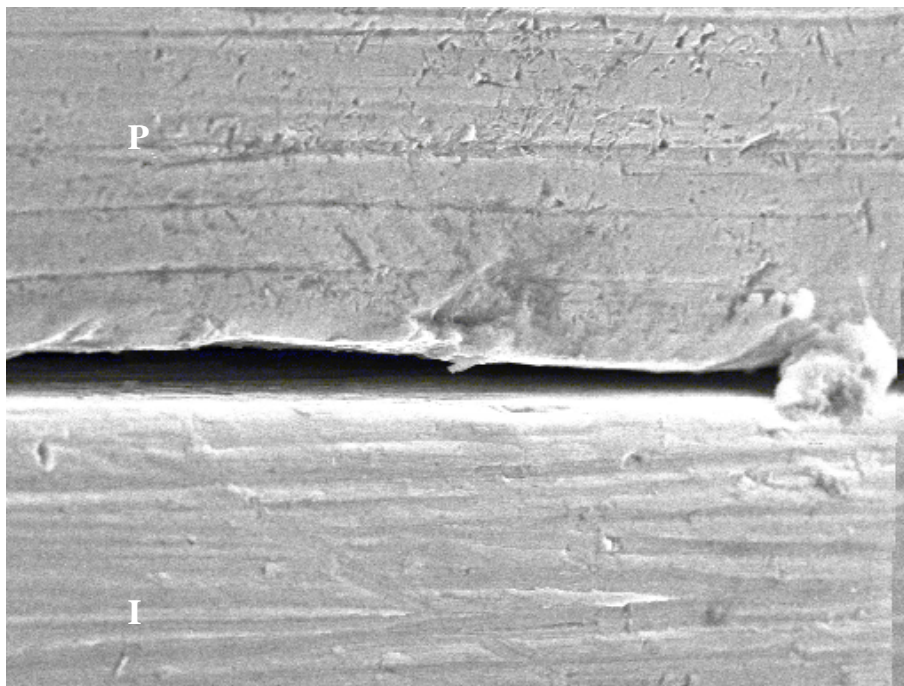
Figura 19. Desadaptação em amostra do sistema SIN, em aumento de 900 vezes
