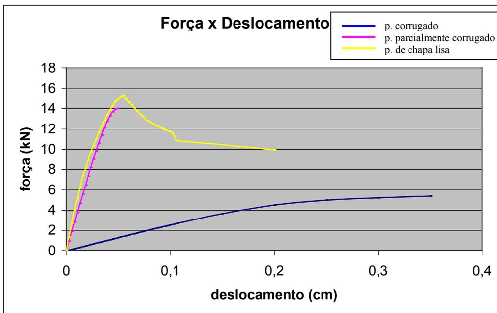
FIG. 4.28 – Força x deslocamento longitudinal do painel
