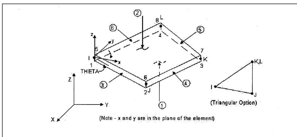
FIG 4.1 – Elemento de placa Shell 63
