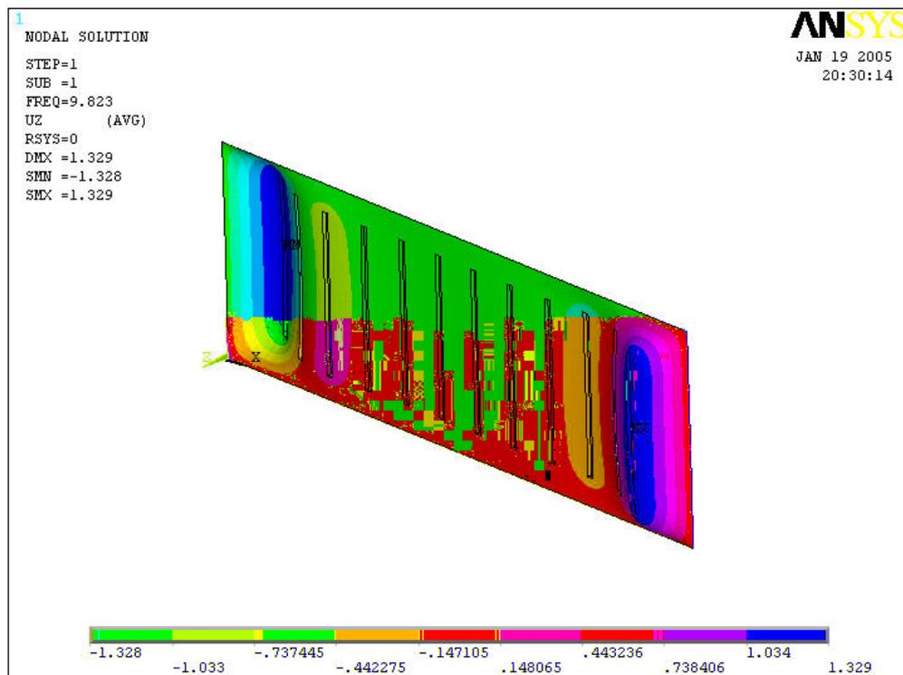
FIG. 4.21 – Superfície de flambagem para o painel parcialmente corrugado
