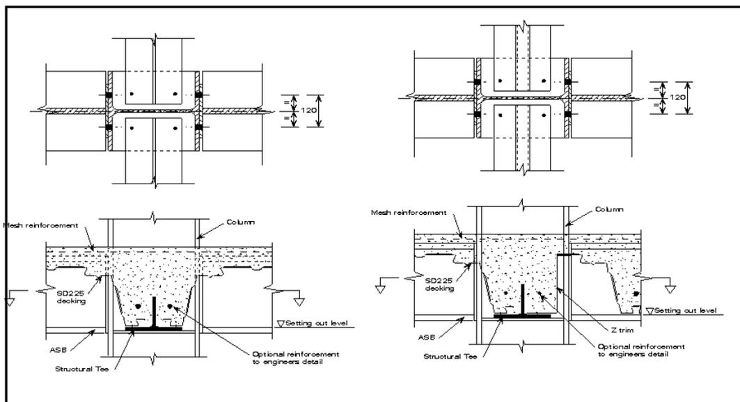
FIG 3.8 – Detalhes construtivos para elementos de travamento de seção T invertido
