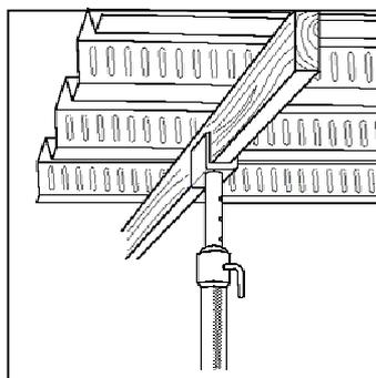
FIG 3.18 – Escoramento provisório durante a fase de concretagem
