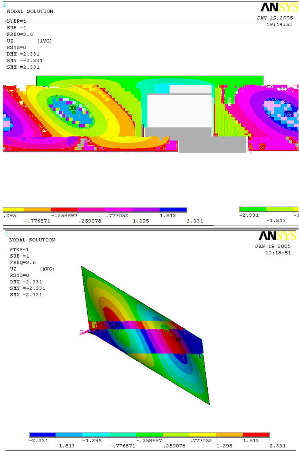
FIG. 4.7 – Superfície de flambagem para o painel de chapa lisa
