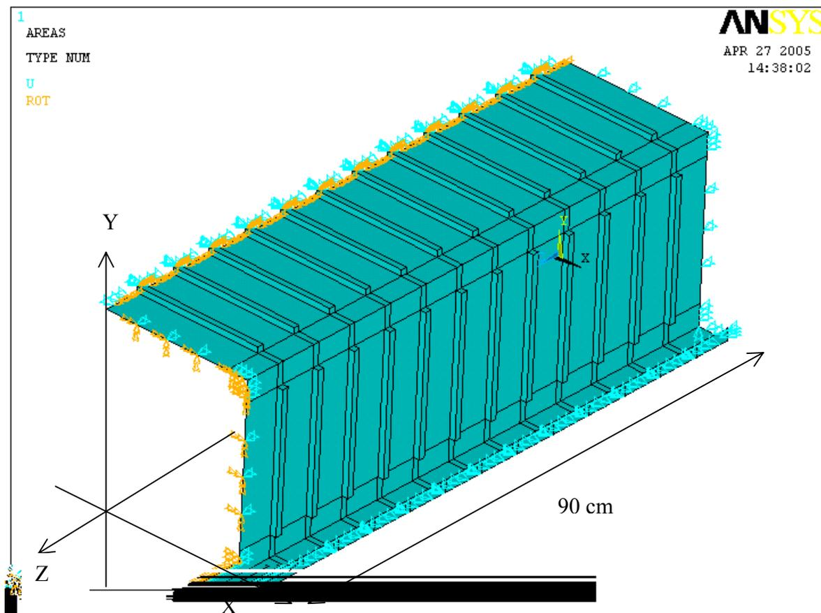
FIG. 4.39 – Modelo utilizado para análise da fôrma
