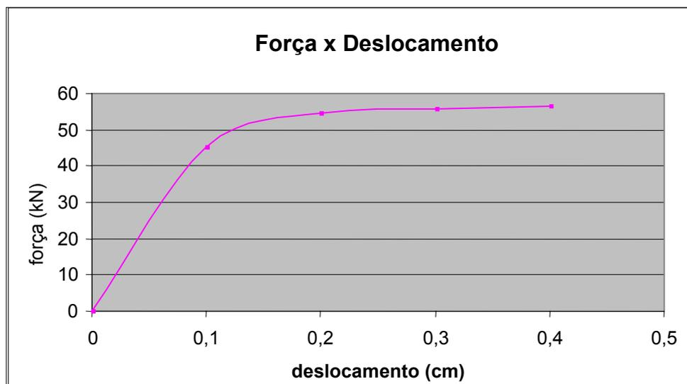
FIG. 4.44 – Gráfico força aplicada x deslocamento longitudinal da fôrma
