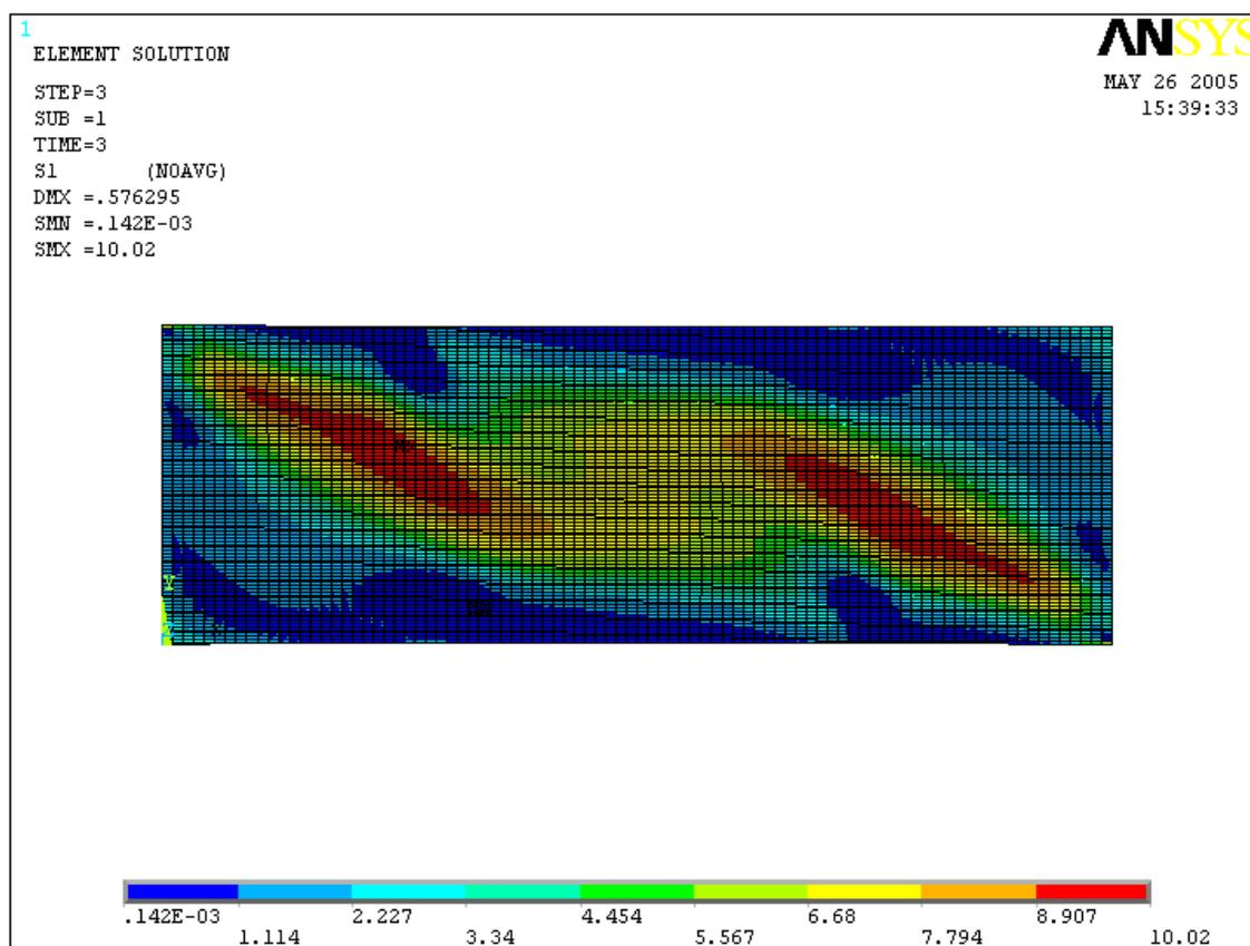
FIG. 4.17 – Tensões principais de tração  $\sigma_1$  para  $F_{rv} = 9$  kN
