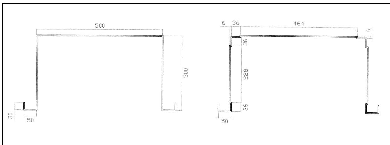
FIG. 4.38 – Seção transversal da fôrma
