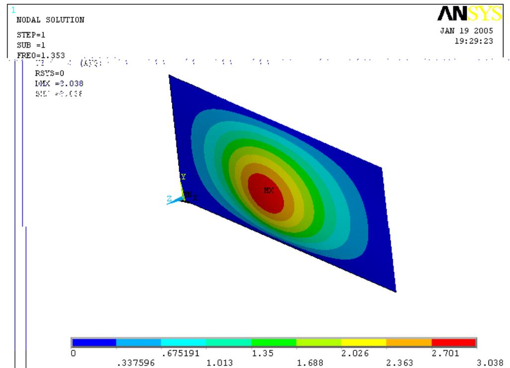
FIG. 4.30 – Superfície de flambagem para o painel de chapa lisa
