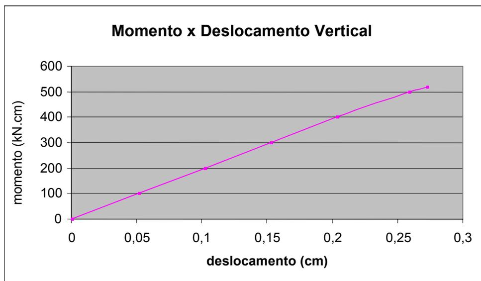
FIG. 4.51 – Gráfico Momento aplicado x deslocamento na extremidade da fôrma
