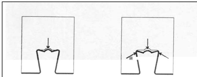
FIG. 3.14 – Resposta da fôrma reentrante ao deslocamento relativo entre o aço e o concreto [Schuurman,2001]
