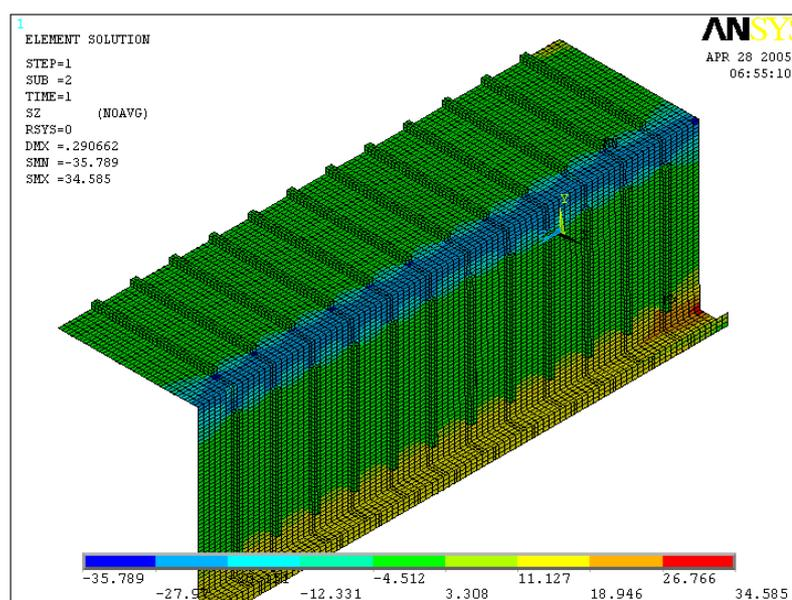
FIG. 4.49 – Tensões  $\sigma_z$  para o momento aplicado de 520 kN.cm
