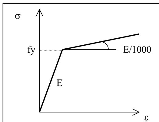
FIG. 4.3 – Modelo de comportamento do material
