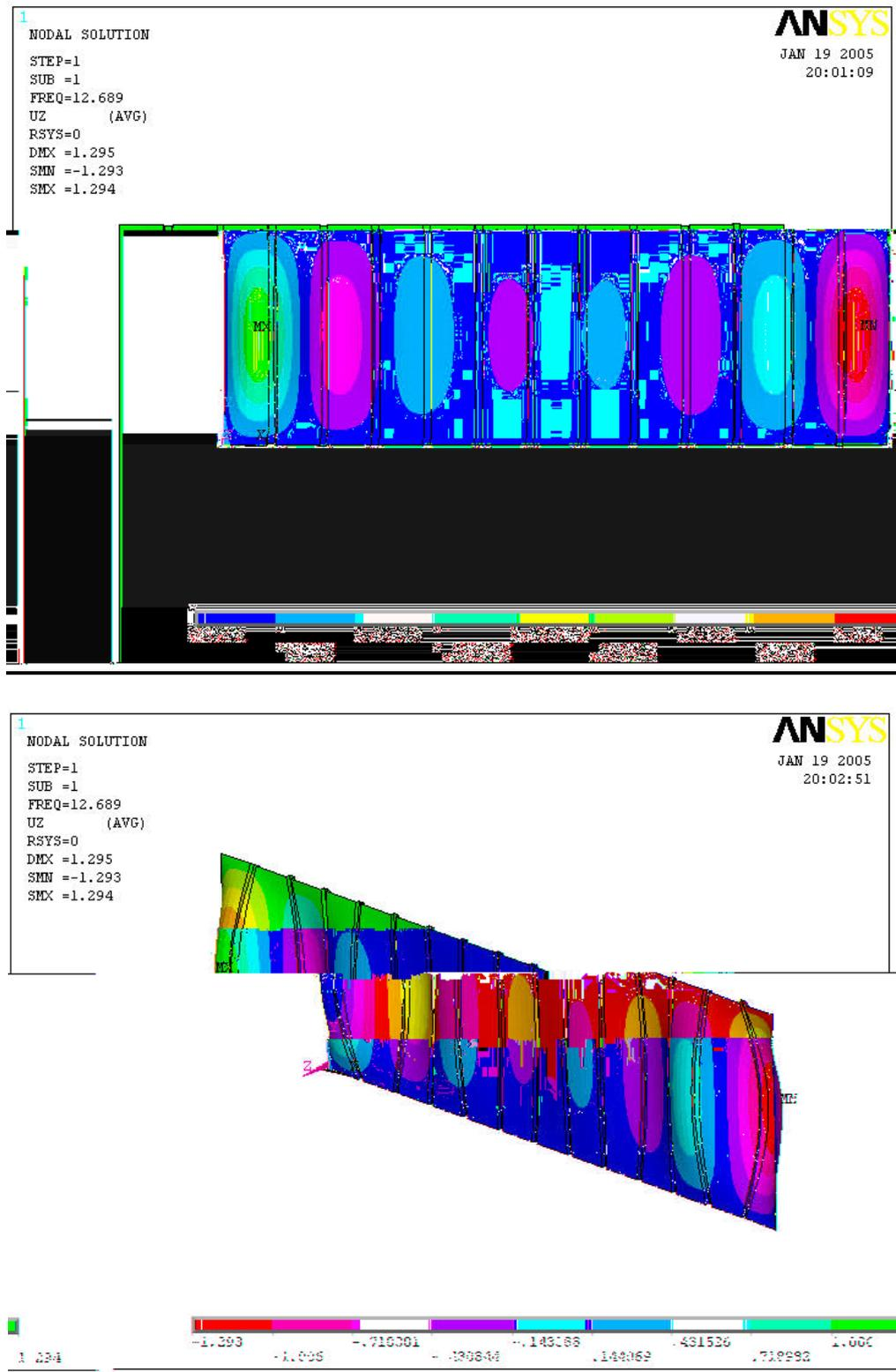
FIG. 4.20 – Superfície de flambagem para o painel corrugado
