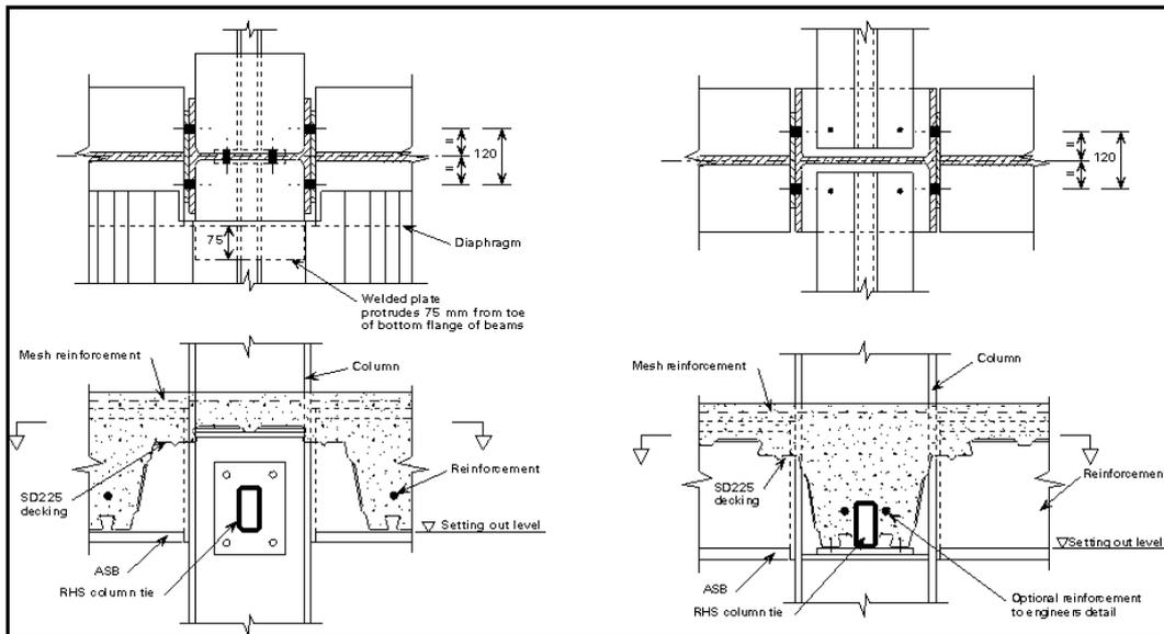
FIG 3.7 – Detalhes construtivos para elementos de travamento de seção tubular
