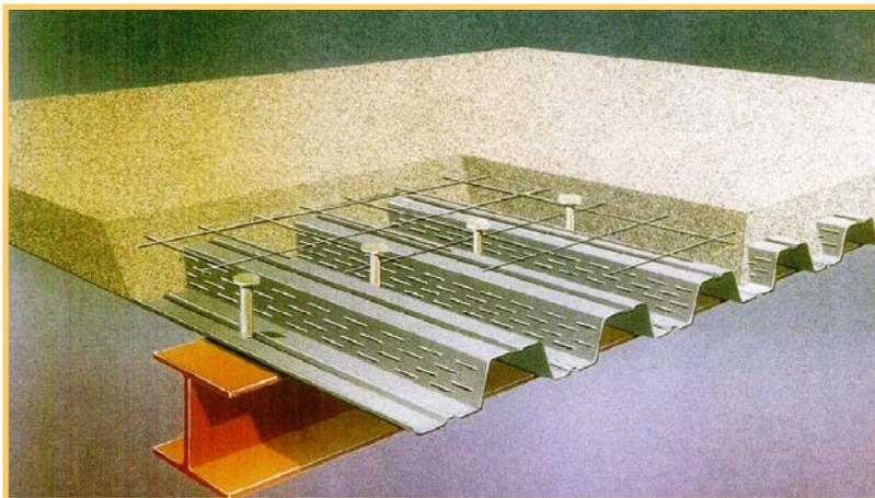
FIG. 1.1 – Sistema de piso misto usualmente utilizado para fôrma convencional
