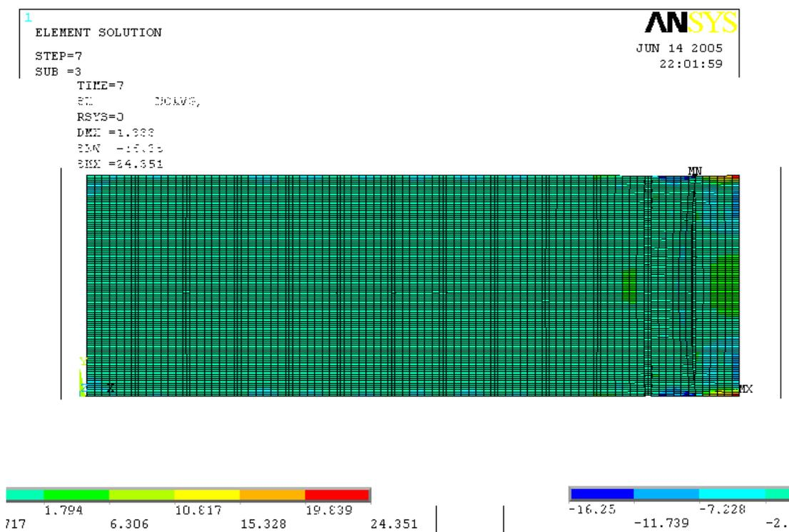
FIG. 4.22 – Tensões de Compressão  $\sigma_x$  para  $F_{comp} = 5,39$  kN atuando no painel de chapa corrugada
