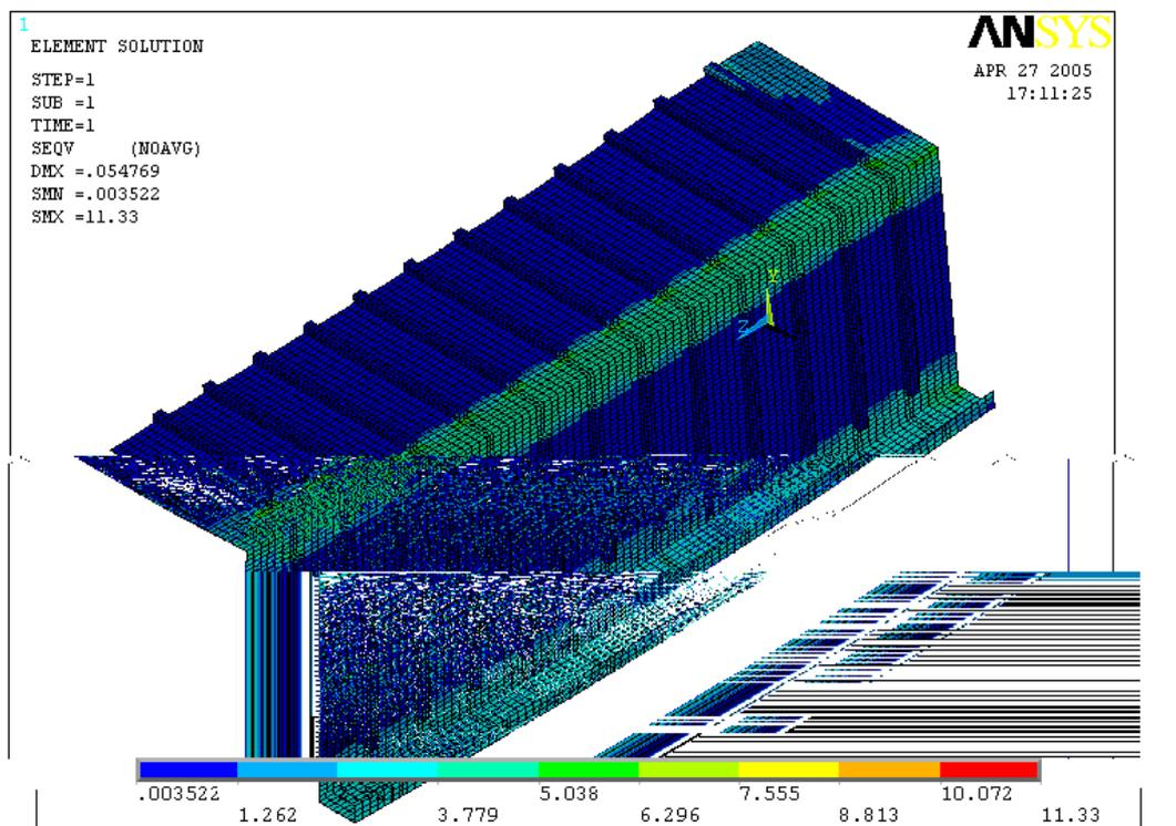
FIG. 4.47 – Tensões de von Mises para o momento aplicado de 100 kN.cm
