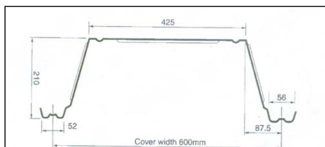
FIG 3.17 – Seção transversal da fôrma CF 210
