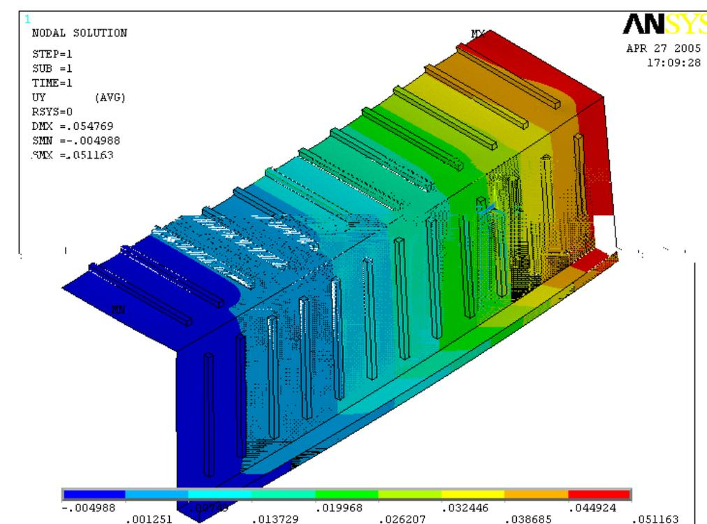
FIG. 4.45 – Deformação na direção Y para o momento aplicado de 100 kN.cm
