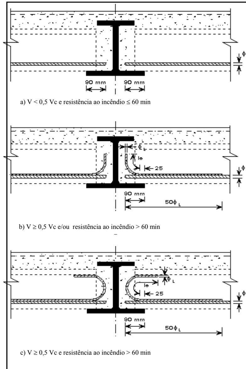
FIG 3.11 – Detalhes da ancoragem da armadura de tração
