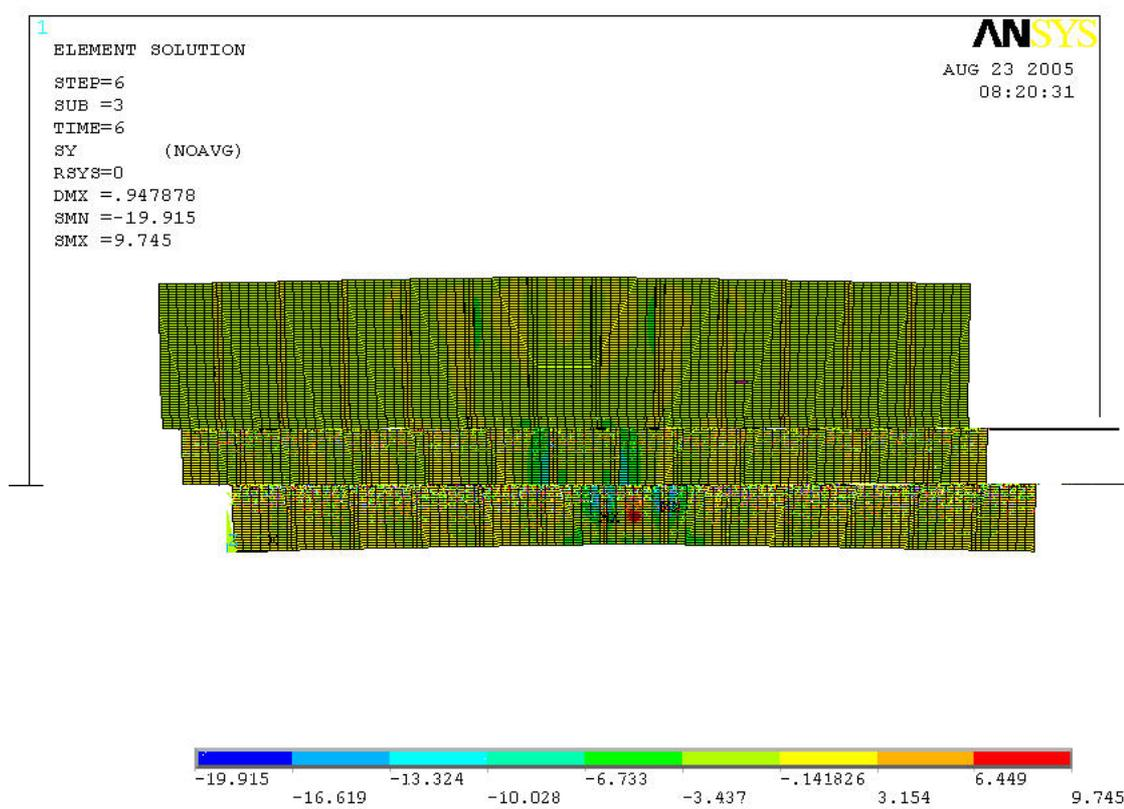
FIG. 4.33 – Tensões  $\sigma_y$  para  $F_{\text{dist}} = 6,0$  kN atuando no painel de chapa corrugada
