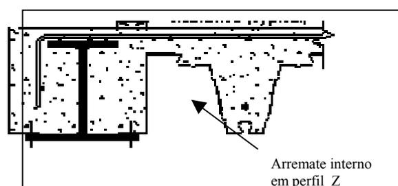
FIG 3.10 – Arremate interno em Z
