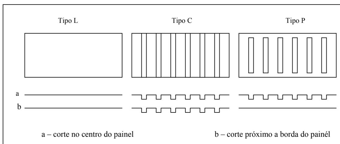
FIG 2.1 – Painéis isolados Tipo L, C e P
