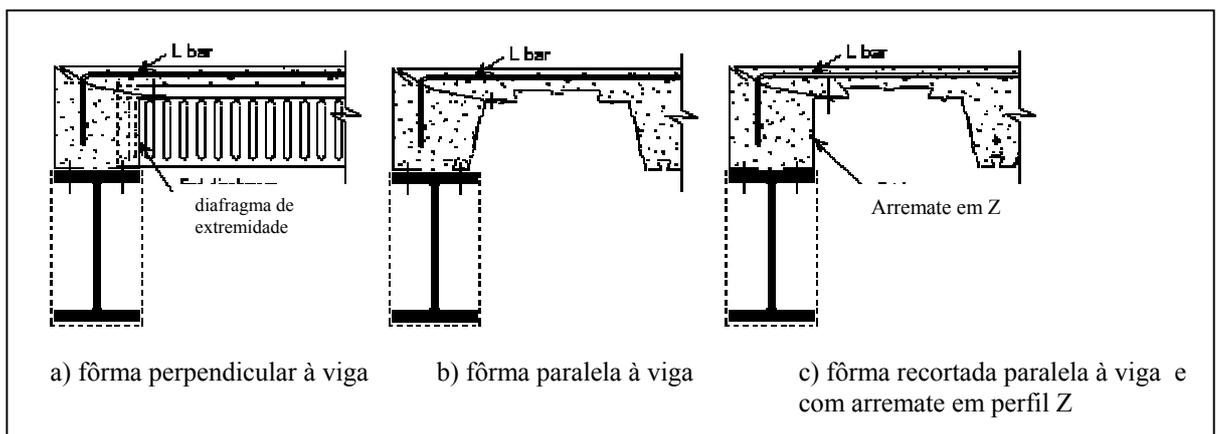
FIG 3.4 – Viga de borda rebaixada, em perfil I, dimensionada como viga de aço isolada (Fonte catálogo da CORUS)
