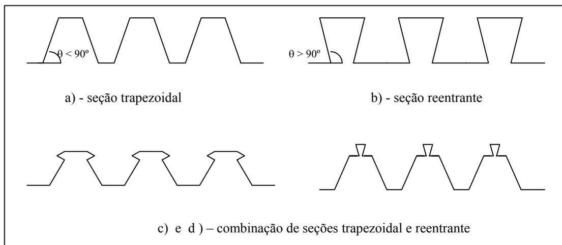
FIG 3.12 – Tipos de seções transversais
