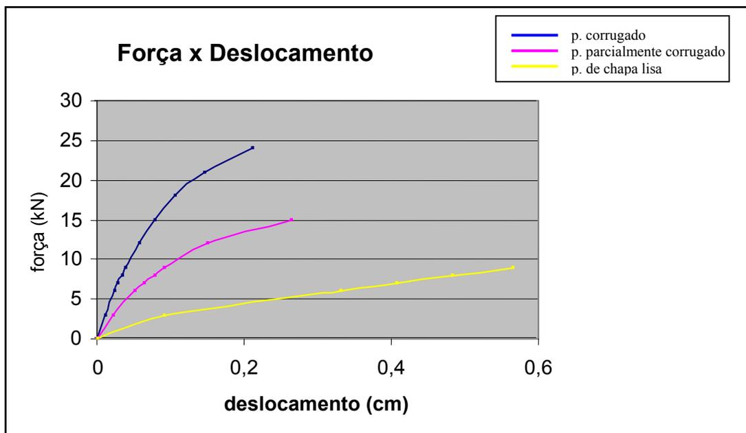
FIG. 4.16 – Força x deslocamento perpendicular ao plano do painel
