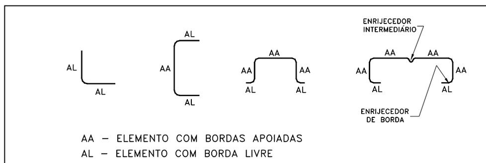
FIG. 3.24 – Elementos constituintes dos perfis (Fonte: NBR 14762)
