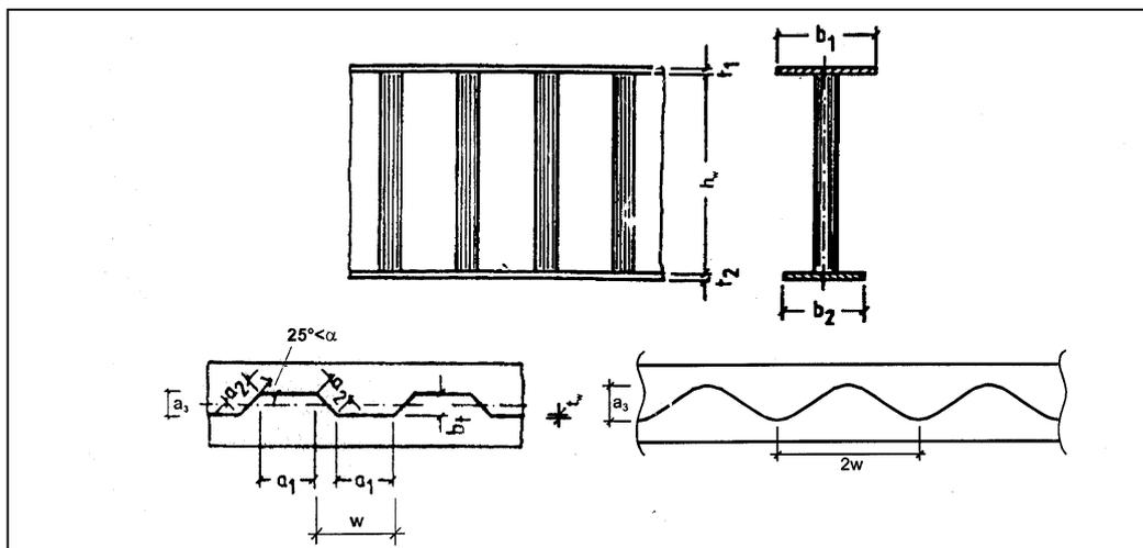
FIG 3.25 – Parâmetros de cálculo utilizados pelo Eurocode (EN 1993-1-5)
