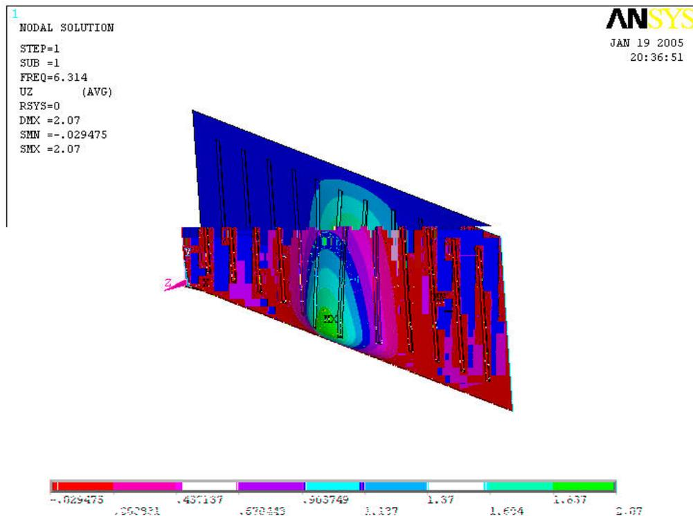
FIG. 4.32 – Superfície de flambagem para o painel parcialmente corrugado
