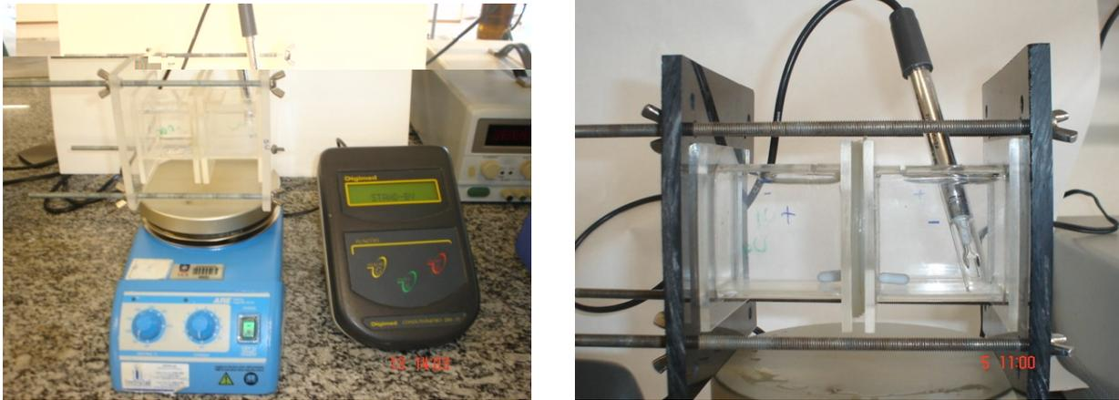
**Figura 14:** Sistema utilizado para medidas de difusão de íons
