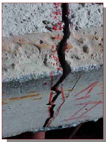
FIGURA 4.18 – Localização da fissura principal – ENSAIO 08
