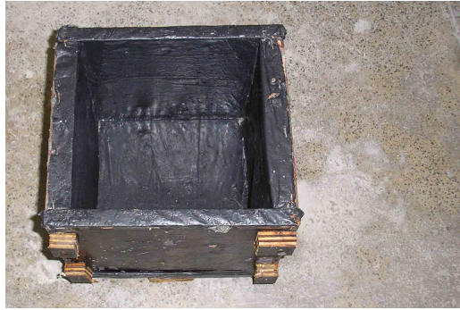
Figura 3.18 – Formas de madeira para a confecção dos corpos-de-prova de concreto.
