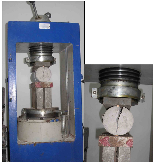
Figura 3.2 – Ensaio à tração por compressão diametral.
