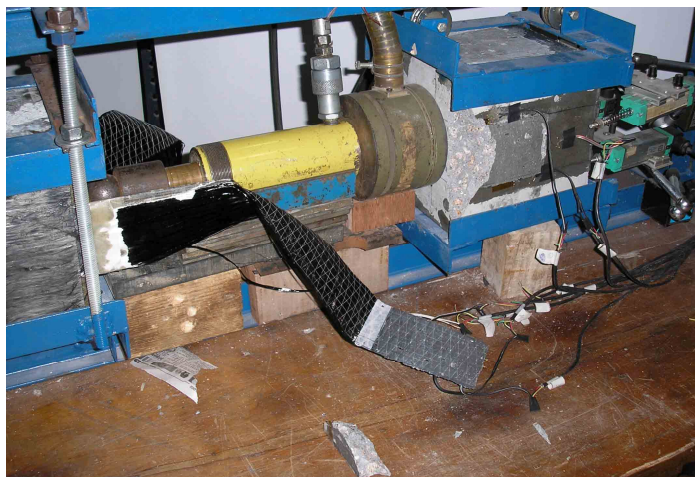
Figura 4.6 – Ruptura por descolamento do tecido com arrancamento do concreto no início da ancoragem do corpo-de-prova MCLIII-1.
