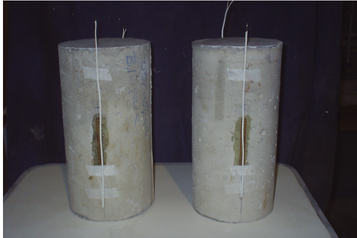
Figura 3.3 – Corpos-de-prova cilíndricos de concreto com extensômetros elétricos de resistência colados à sua meia altura.
