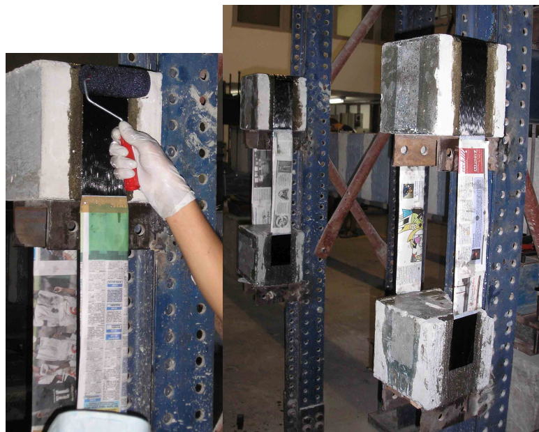
Figura 3.22 – Aplicação do tecido no corpo-de-prova.
