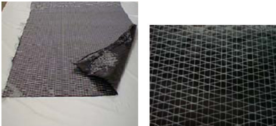
Figura 3.11 – Verso do tecido de fibra de carbono tipo N-300 com destaque para a costura.
