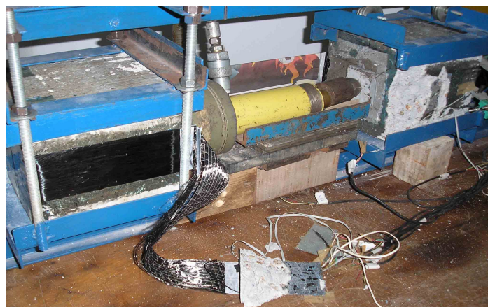
Figura 4.9 – Ruptura por arrancamento do substrato de concreto no início da ancoragem do corpo-de-prova MCRI-2.
