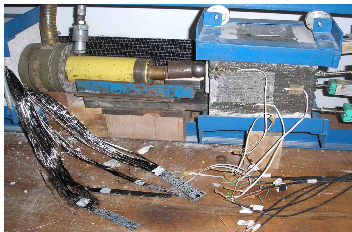
Figura 4.14 – Ruptura por descolamento seguido de separação das fibras do tecido de CFC do corpo-de-prova MCRIII-2.
