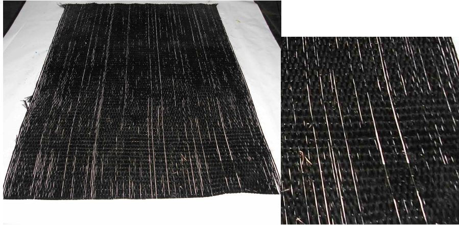
Figura 3.30 – CFC inadequado para os ensaios de aderência, com destaque para as aberturas da malha e sentido das fibras.
