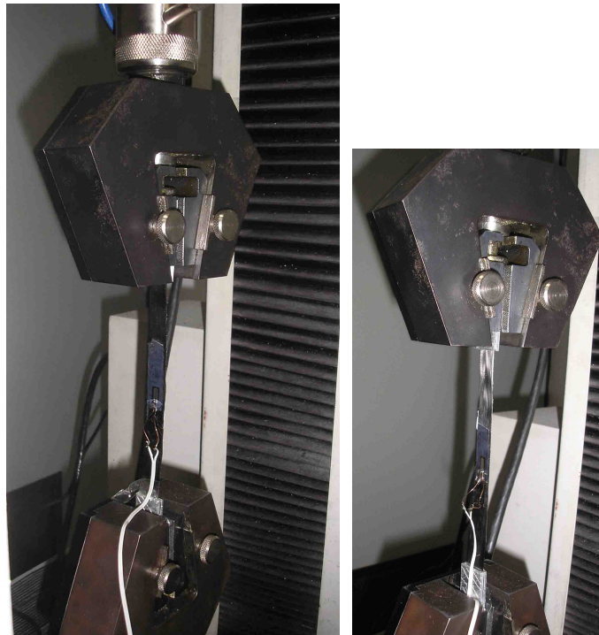
Figura 3.15 – Ensaio dos corpos-de-prova de compósitos de fibra de carbono com placas de alumínio nas extremidades.
