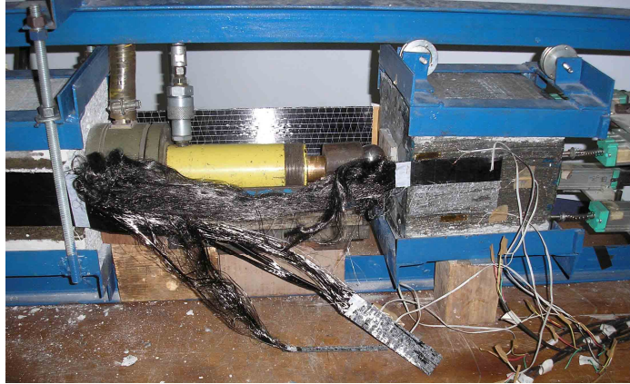
Figura 4.19 – Ruptura por descolamento seguido de separação das fibras do tecido de CFC do corpo-de-prova CDRIII-1.
