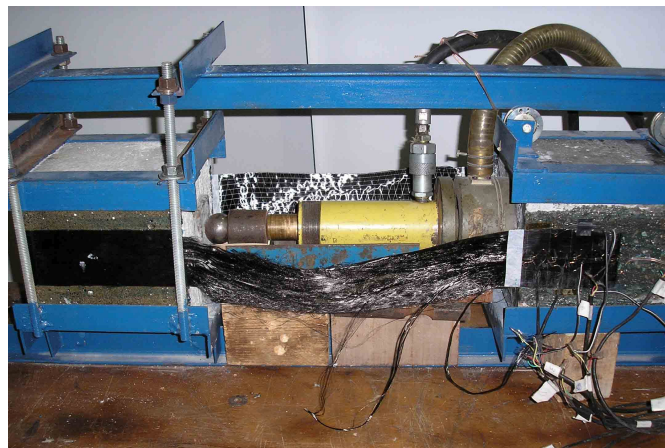
Figura 4.8 – Ruptura no tecido de CFC ao longo do comprimento descolado do corpo-de-prova MCRI-1 (corpo-de-prova descartado).
