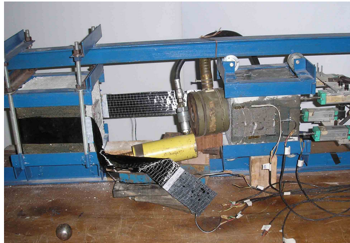
Figura 4.7 – Ruptura por descolamento do tecido com fissuras no bloco de concreto no início da ancoragem do corpo-de-prova MCLIII-2.
