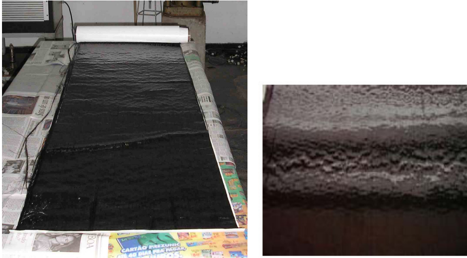
Figura 3.10 – Tecido de fibra de carbono, tipo N-300.
