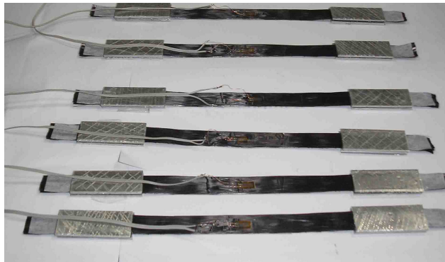
Figura 3.12 – Corpos-de-prova CFC revestidos com resina epóxi.
