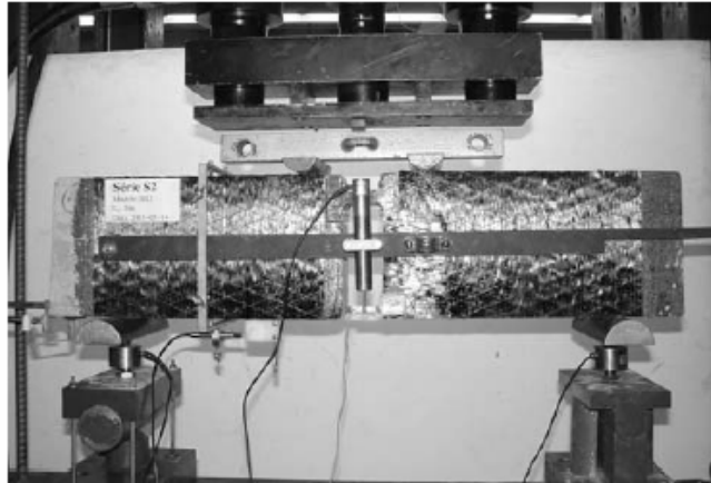
Figura 2.12 – Reforço de CFC para força cortante; adaptada de Cruz e Barros (2001).
