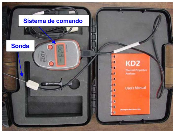
Figura 4.50 – Instrumento 'Thermal Properties Analysis', do tipo KD2
