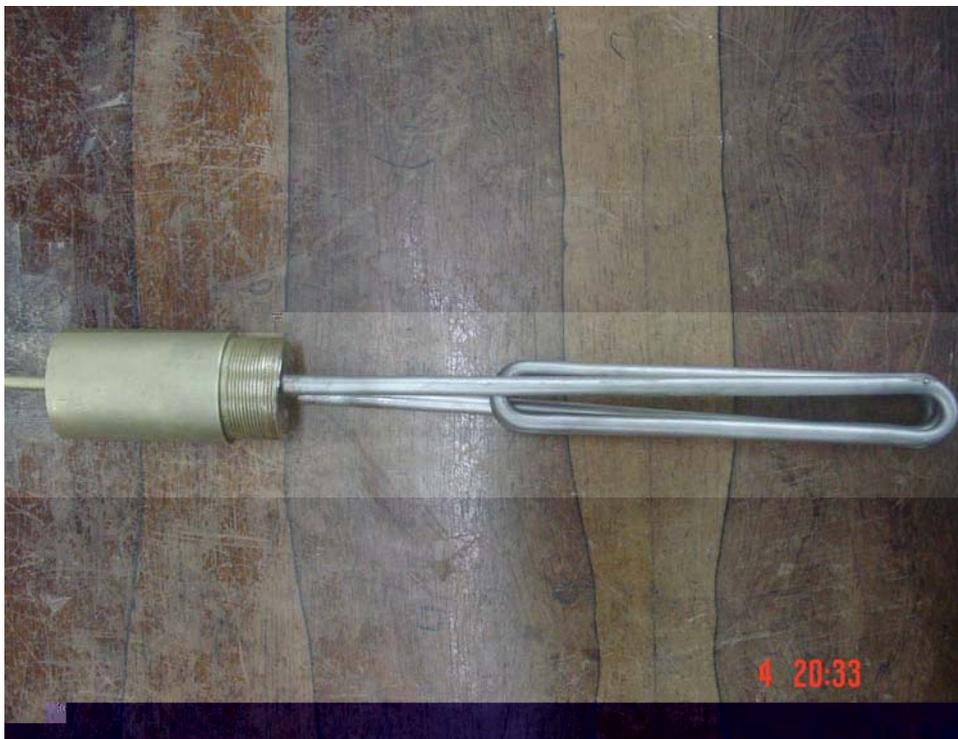
Figura 4.72 - Novo cartucho de resistência (vista superior)
