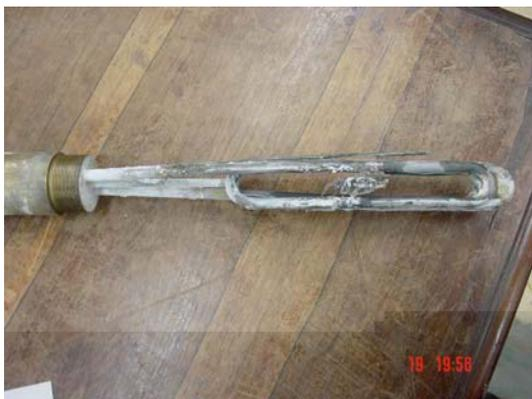
Figura 4.81 – Cartucho de resistência danificado (1)
