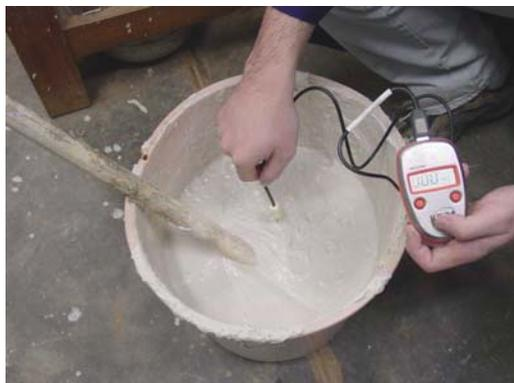
Figura 4.68 – Medição dos parâmetros térmicos da mistura caulim-água
