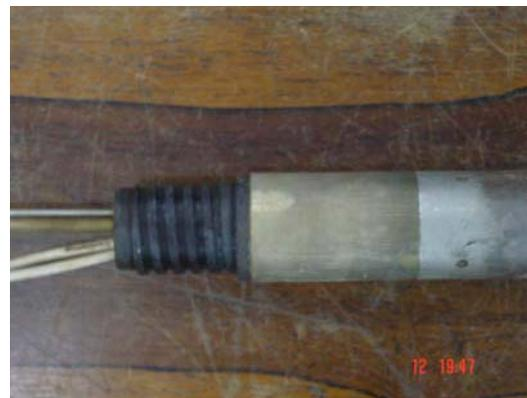
Figura 4.77 – Detalhe da conexão entre o cartucho e o tubo inferior do bastonete
