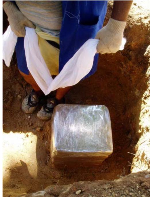
Figura 4.45 – Isolamento do bloco
