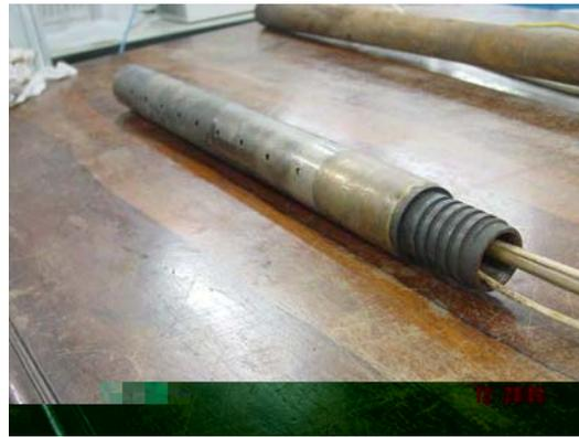
Figura 4.79 – Detalhe do novo aquecedor do bastonete térmico
