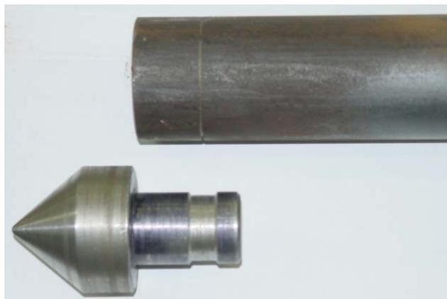
Figura 3.15 – Detalhe do acabamento da ponta da sonda
