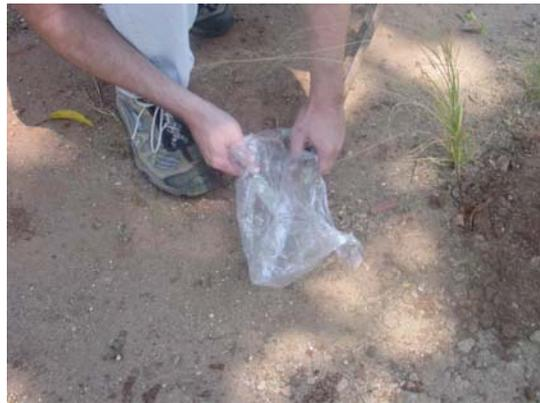
Figura 4.32 – Recolhimento de amostras para determinação de umidade
