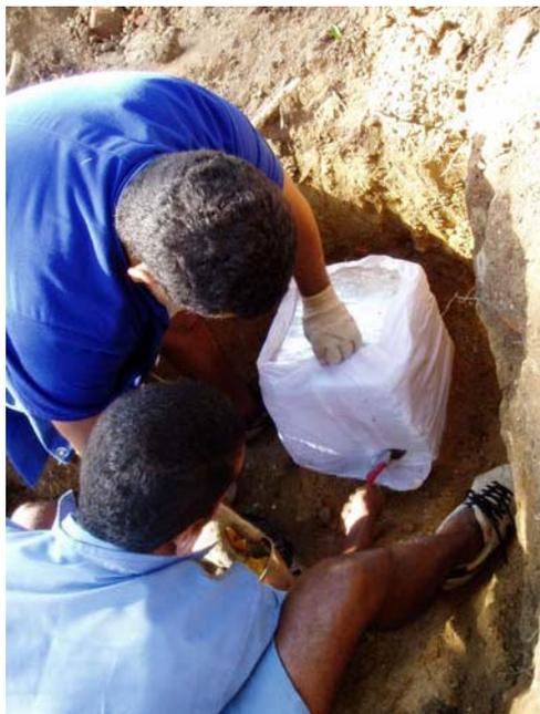
Figura 4.46 – Isolamento do bloco
