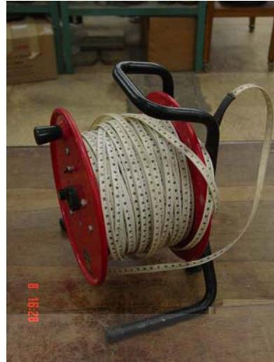
Figura 4.17 – Medidor de nível d'água elétrico portátil (2)
