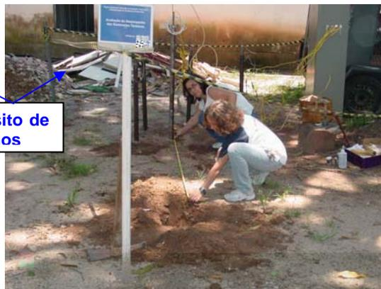
Figura 4.30 – Medição da distância do local de extração de amostras até o bastonete
