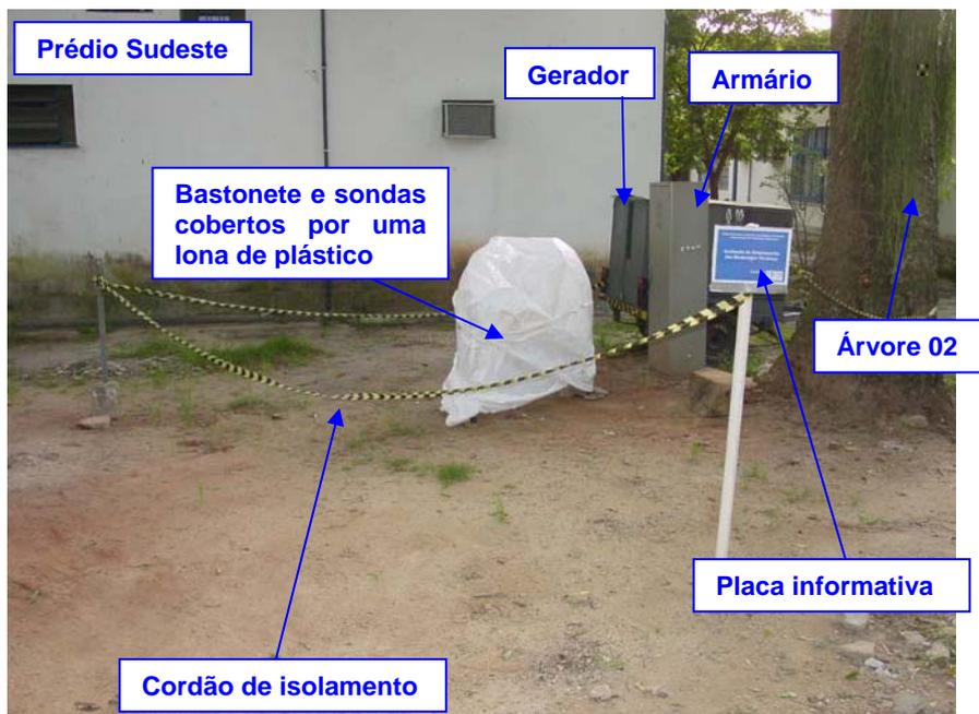
Figura 4.25 – SDTIS instalado na **EMBRAPA Solos**, vista geral
