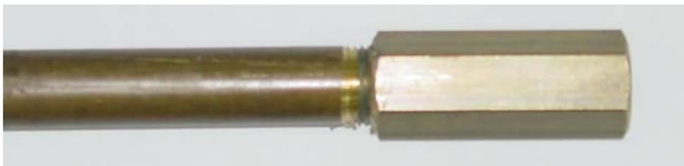
Figura 3.10 – Detalhe da luva de conexão entre as tubulações-guia do termopar interno
