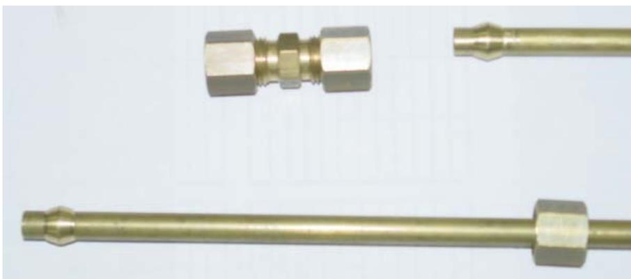
Figura 3.9 – Detalhe da conexão (anilhas) entre as tubulações de injeção de ar
