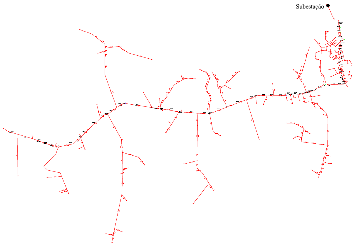
Figura 5.3 – Mapa dos trechos primários do alimentador piloto modelado computacionalmente.
