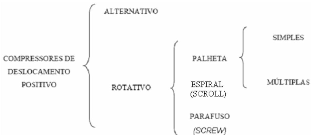
Figura 5 – Classificação de compressores de refrigeração
