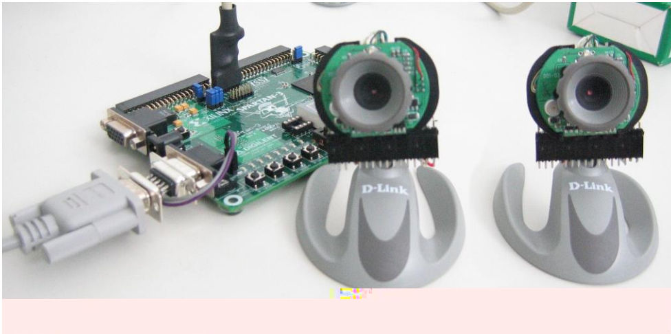
Figura 32 – Hardware utilizado na pesquisa. Kit de desenvolvimento da Xilinx e duas câmeras CMOS modificadas.
