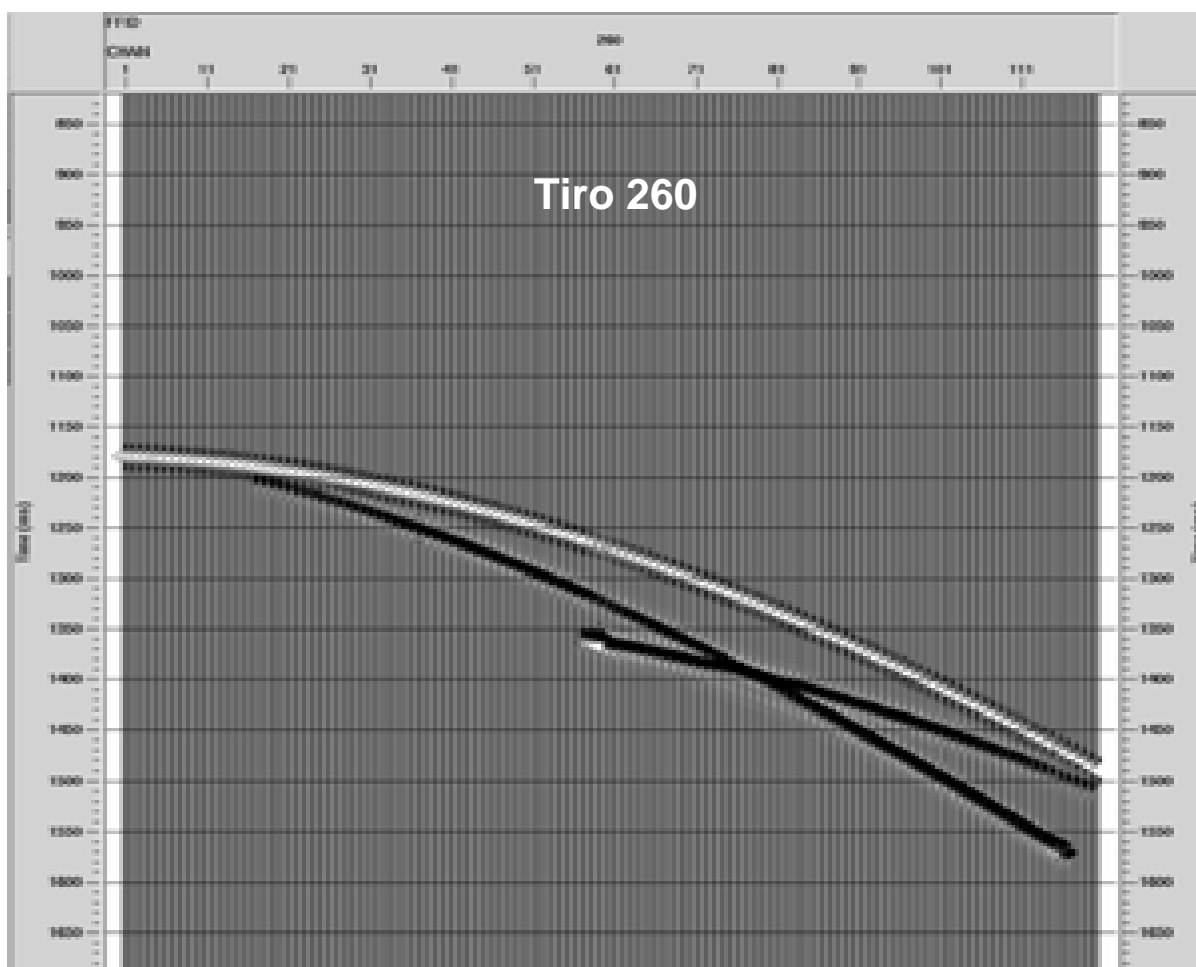
Figura 7.13 – Sismograma Tiro 260, referente ao modelo inicial. Observar o efeito do foco enterrado no refletor referente a base do canal.
