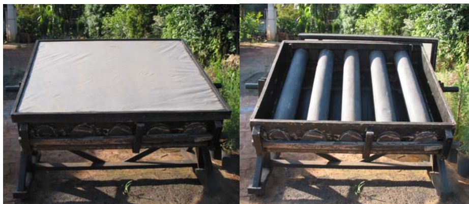
Figura 1 – Coletor solar utilizado para a solarização do substrato empregado nos ensaios em casa-de-vegetação
