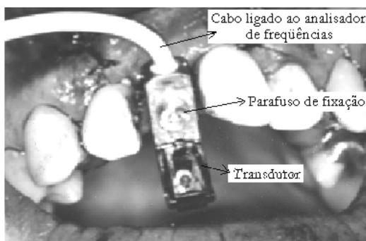
Figura 4. *Osstell™* medindo a *FR* da estrutura implante-transdutor.
