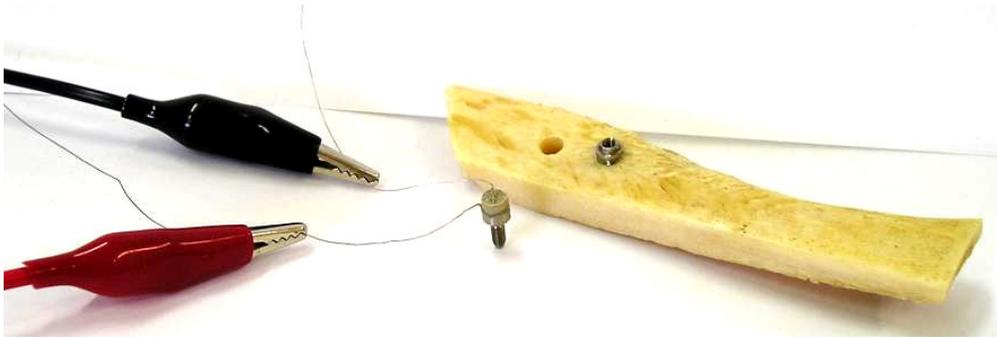
Figura 19. Guia de onda de titânio (cp 2) com 9,7 mm de comprimento ligado ao circuito gerador de pulsos de ultra-som ao lado do implante inserido em osso bovino.
