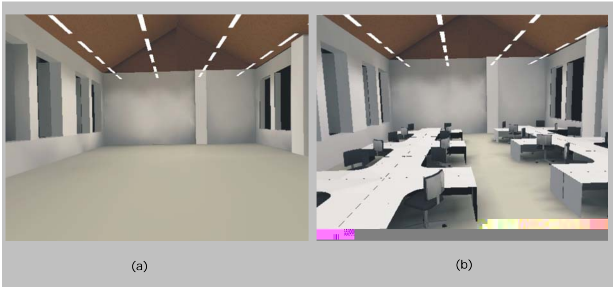
FIGURA 5.11 – RESULTADO DO CÁLCULO E RENDERIZAÇÃO DA SIMULAÇÃO NO LUMEN DESIGNER DE PARTE DO PAVIMENTO COM PAREDE BRANCA PARA O SISTEMA 1 SEM MOBILIÁRIO (a) E COM MOBILIÁRIO (b)
