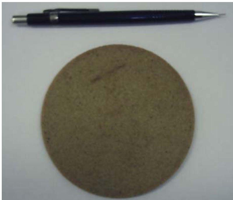
Figura 31: Pedra porosa antes da passagem do lixiviado
