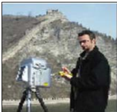
Figura nº 4.23 – Scanner a Laser 3D da Mensi
