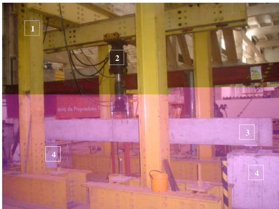
Figura 3.18 – Máquina de ensaio de vigas de aço. (1) pórtico; (2) macaco hidráulico; (3) viga; (4) apoios.
