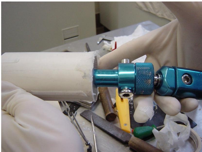
Figura 8- Coaptação do modelo biomecânico de joelho ao sulco de cimento ósseo – São Paulo – 2006
