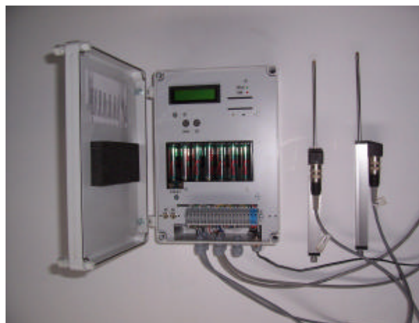
Foto IV.14 – Sistema de aquisição automática de dados “Datenlogger” e dois dispositivos de medição (horizontal e vertical).
