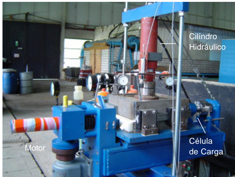
Foto IV.12 – Caixa de cisalhamento direto de média escala (300 x 300 x 150 mm).
