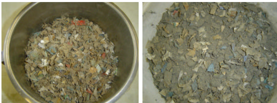
Foto IV.3 – Preparação da mistura argila- fibra de resíduo sólido (largura: 5-10 mm e comprimento: 15-30 mm; porcentagem de fibras: 2 %).
