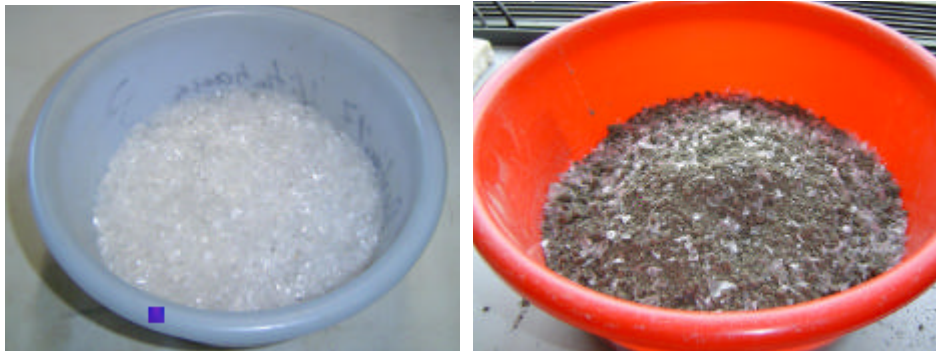
Foto IV.2 – Preparação da mistura argila-fibra geotécnica (polietileno de baixa densidade; largura: 5-10 mm e comprimento: 10–20 mm; porcentagem de fibras: 2 %).
