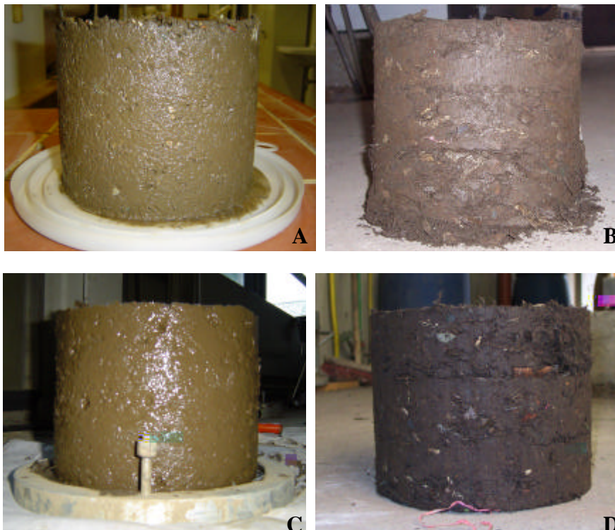
Foto IV.7 – Amostras de resíduos sólidos após ensaio de compactação. A) Resíduo velho ( \varphi < 8 mm; w = 30\% ). B) Resíduo velho ( \varphi < 30 mm; w = 23\% ). C) Resíduo velho ( \varphi < 30 mm; w = 30\% ). D) Resíduo pré-tratado ( \varphi < 40 mm; w = 35\% ).
