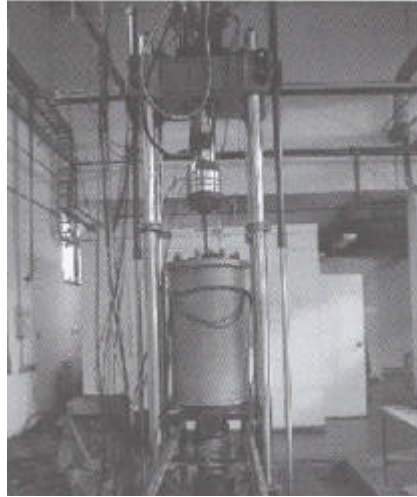
Foto II.2 - Equipamento experimental em laboratório para ensaio triaxial de grande escala – CAICEDO et al. (2002).
