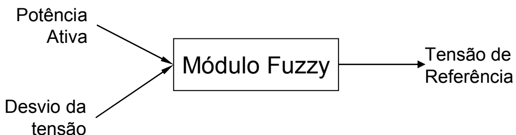
FIGURA 4.9 – Módulo inteligente agregado ao relé regulador de tensão.
