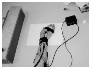
Figura 10: Mão instrumentada para realização do experimento, Fagarasanu et al. (2004)
