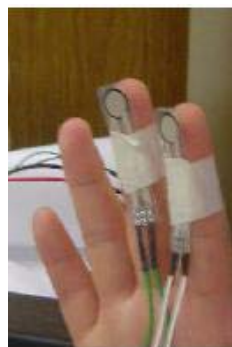
Figura 52: Posicionamento do sensor de força na mão
