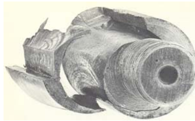
Figura I.5 – Ruptura por fadiga com iniciação na superfície da aresta inferior do entalhe do componente. (POLAKOWSKI, 1966)
