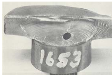
Figura I.6 – Ruptura por fadiga com iniciação na superfície do componente. (POLAKOWSKI, 1966)
