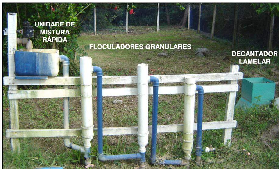
Figura 4-3: Sistema de pós-tratamento físico-químico.
