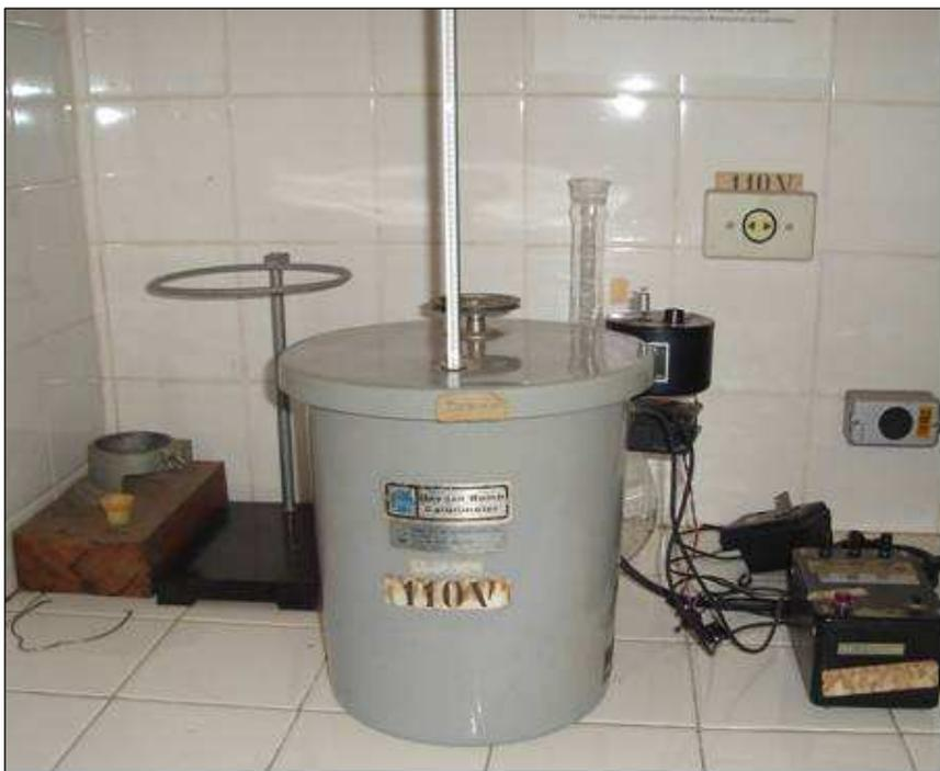
Figura 12 - Bomba calorimétrica Tipo Parr
