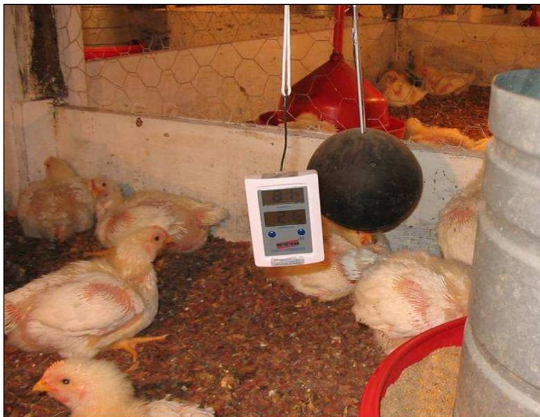
Figura 14 – Equipamentos para medições de temperatura e UR ar
