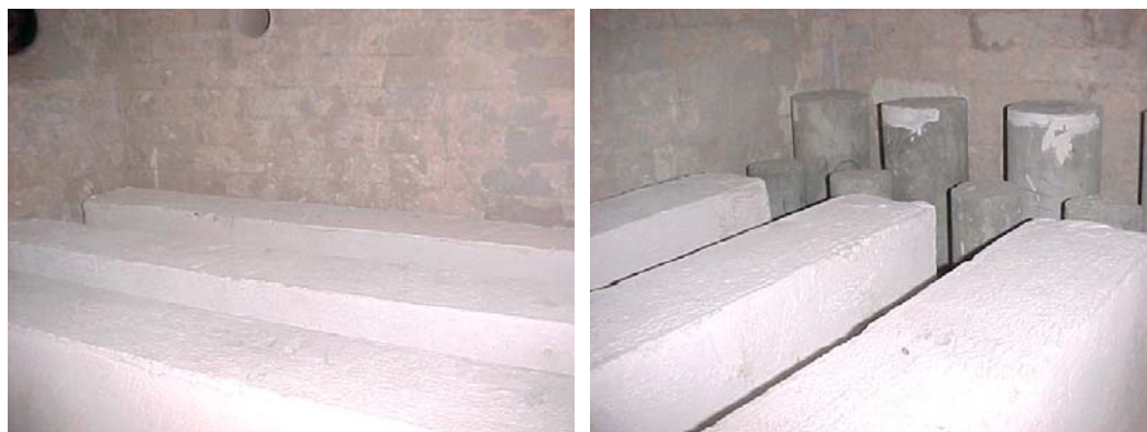
Figura 3.9 – Distribuição das vigas e corpos-de-prova para exposição
