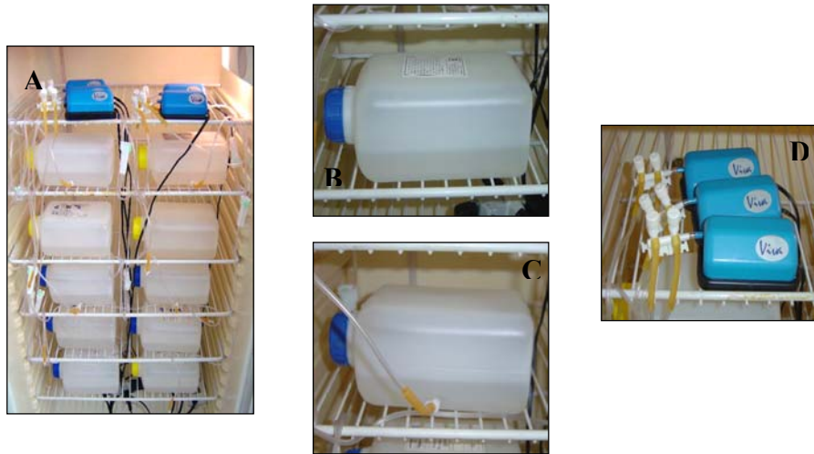
Figura 1. A. Potes plásticos contendo suspensões de nematóides armazenadas com e sem aeração em câmara climatizada tipo BOD; B. Pote plástico contendo suspensão de nematóides sem aeração; C. Pote plástico contendo suspensão de nematóides com aeração; D. Compressor de ar para aquário.
