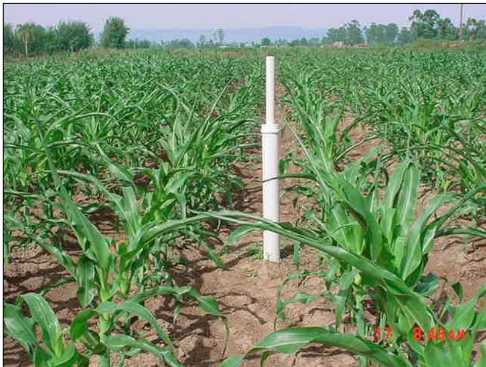
Figura 8: Poço de monitoramento PM1 localizado na Área Piloto. Santa Rosa do Sul/SC.
