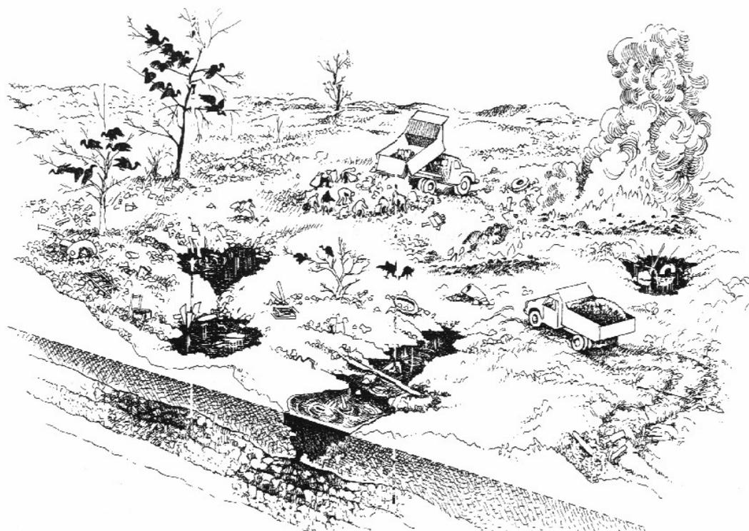
Figura 4 - Esquema de um lixão a céu-aberto mostrando a presença dos catadores e animais no local de descarga dos caminhões e o acúmulo de chorume na superfície do solo, bem como a sua absorção pelas camadas do solo.
