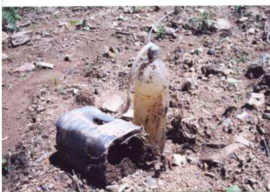
Figura 21. Aspecto de amostrador de colúvio após evento de 93mm que gerou coleta em outubro de 2003.
