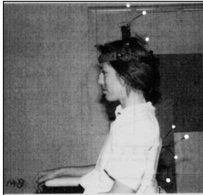
Figura 2.10 – Foto ilustrando o posicionamento e as localizações dos marcadores no voluntário. fonte: (WOLTRING et al , 1994).
