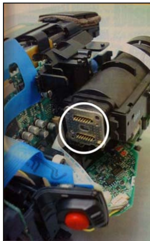
Figura 3.3 – Foto ilustrando a localização do CCD dentro da câmera. fonte: (CAMCORDER & COMPUTER VIDEO, 2000).
