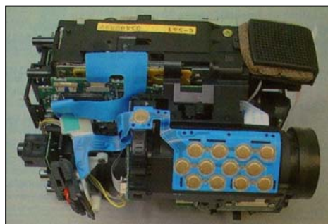
Figura 3.2 – Foto ilustrando a parte inferior de uma câmera desmontada. fonte: (CAMCORDER & COMPUTER VIDEO, 2000).
