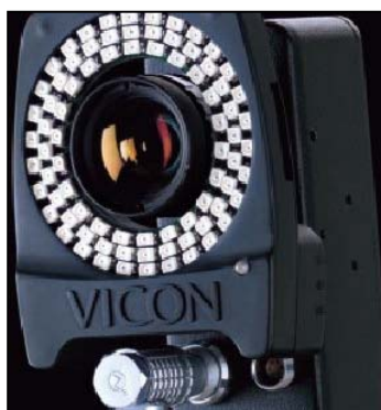
Figura 3.9 – Foto ilustrando uma câmera especial para análise do movimento. fonte: ( http://www.vicon.com/Engineering/support/downloads/tech%20sheets/VMS066A_VR05.pdf )
