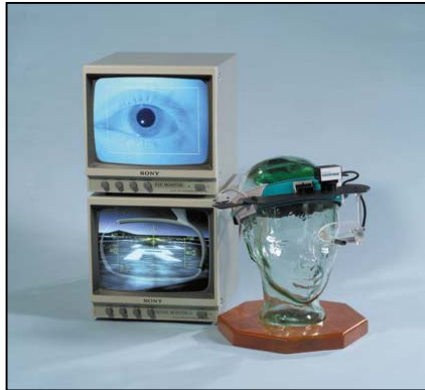
Figura 2.2 – Foto ilustrando o sistema comercial VisionTrak ® fonte: ( http://www.polhemus.com/eyetracking.htm )
