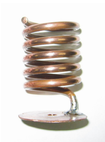
Figura 5.4 Helicóide soldada em um disco de cobre, para fixação na tampa inferior da cavidade do ressonador helicoidal.
