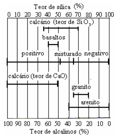
Figura 2.5: Sistema Mertons e Wright (adaptado de HICKS, 1991).
