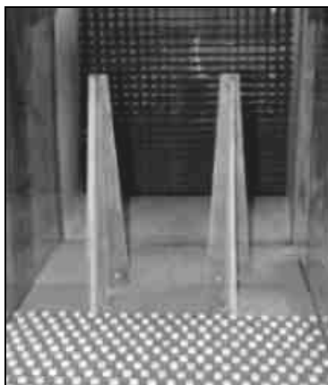
Figura 5.2. Elementos de rugosidade e simuladores utilizados na simulação parcial no TV2.
