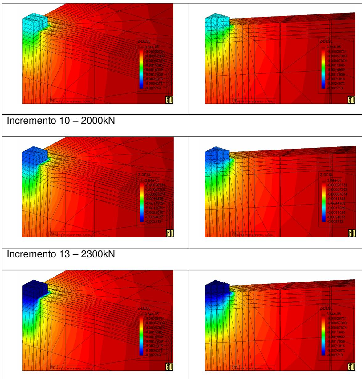
Figura 6.4 – Configuração 1 – Distribuição dos deslocamentos verticais.
