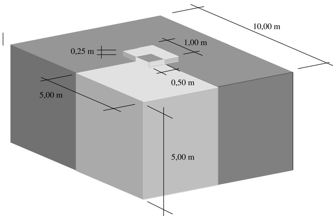
Figura 6.1 – Geometria e simetria utilizada na simulação de sapata isolada (fora de escala).
