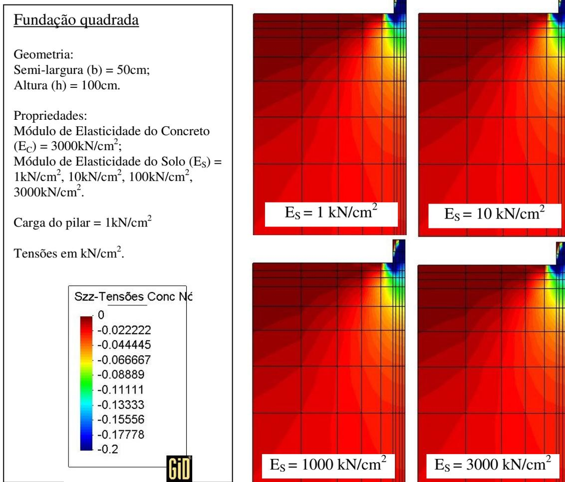
Figura 5.5 – Fundação rígida em diferentes solos – Distribuição de tensões.
