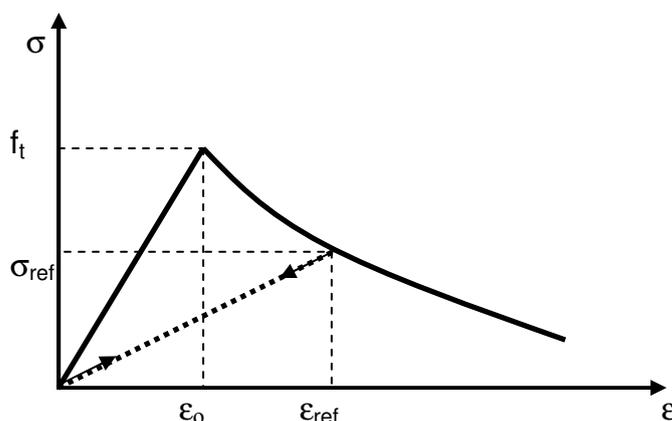
Figura 4.6 – Curva tensão-deformação para o concreto tracionado segundo o modelo de Hinton (1988)
