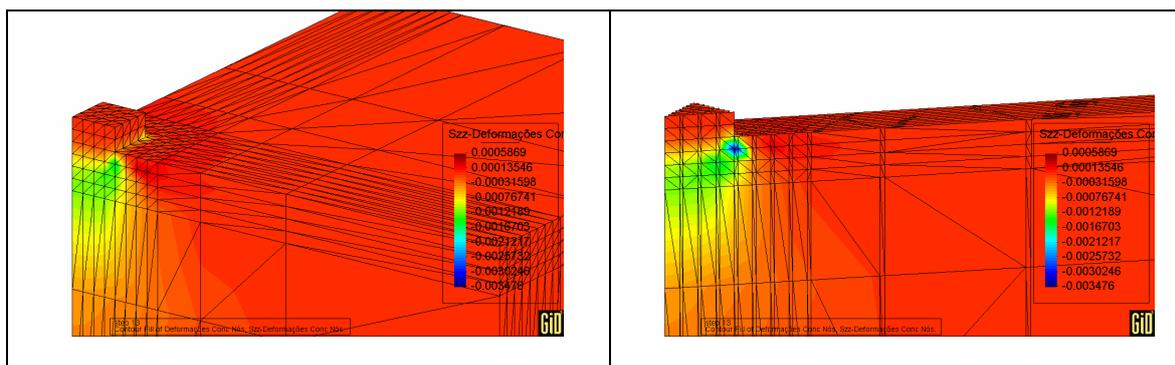
Figura 6.11 – Configuração 2 – Distribuição das deformações específicas normais verticais.
