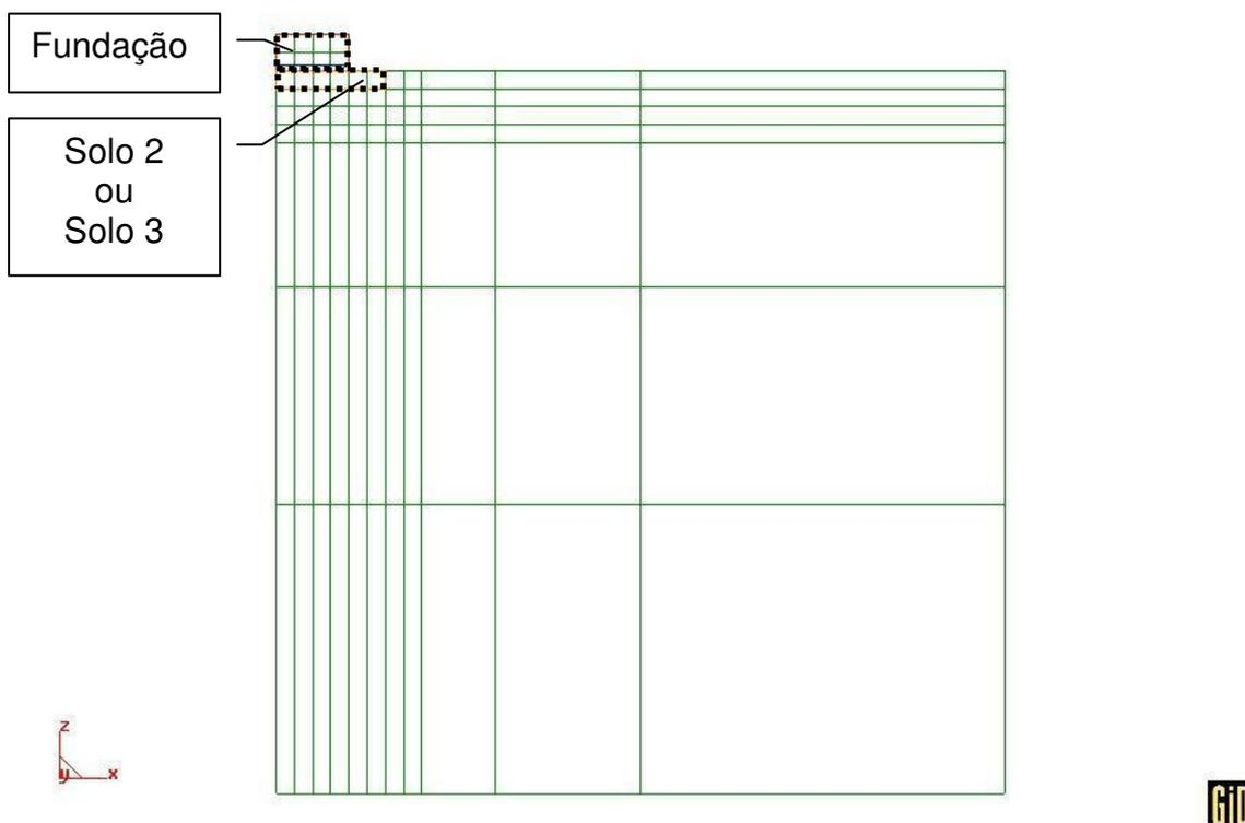
Figura 6.3 – Vista frontal (XZ) da malha utilizada.
