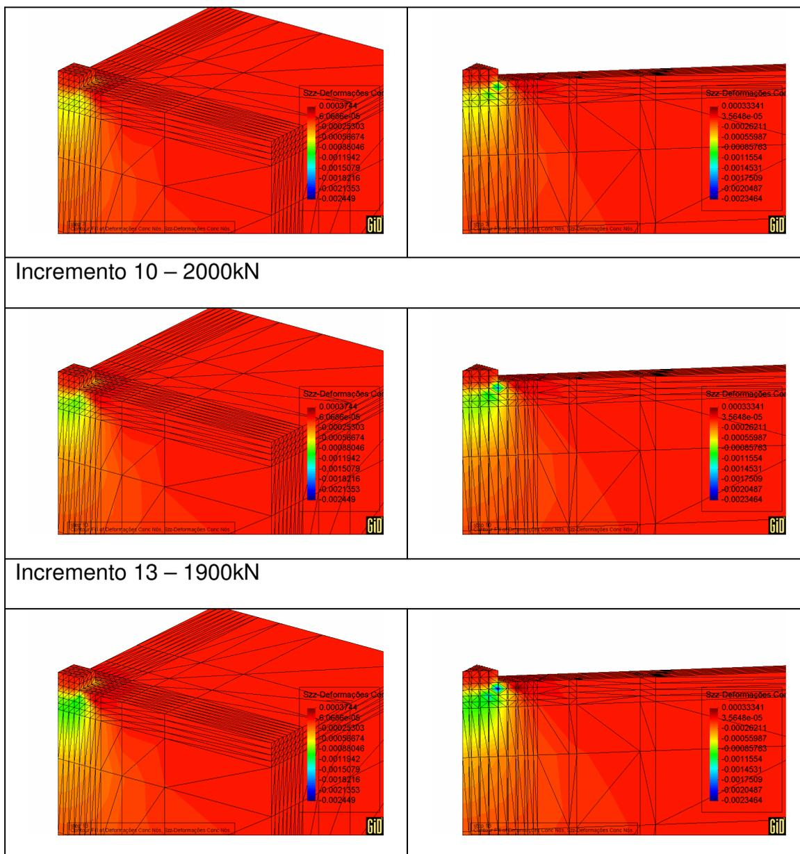
Figura 6.16 – Configuração 3 – Distribuição de deformações específicas normais verticais
