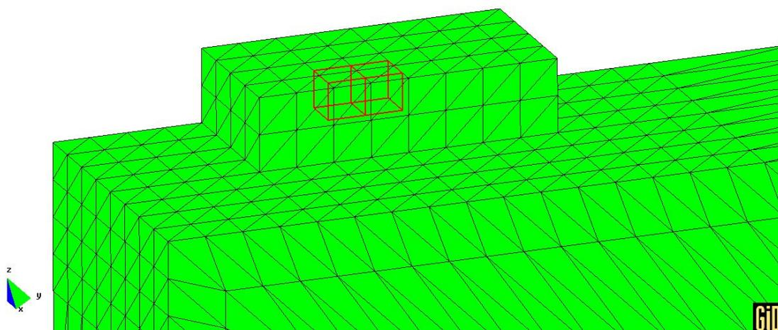
Figura 6.37 – Elementos da fundação que apresentaram fissuração.
