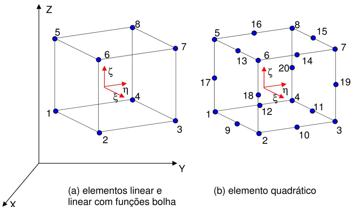
Figura 2.1 – Tipos de elementos finitos para concreto e solo
