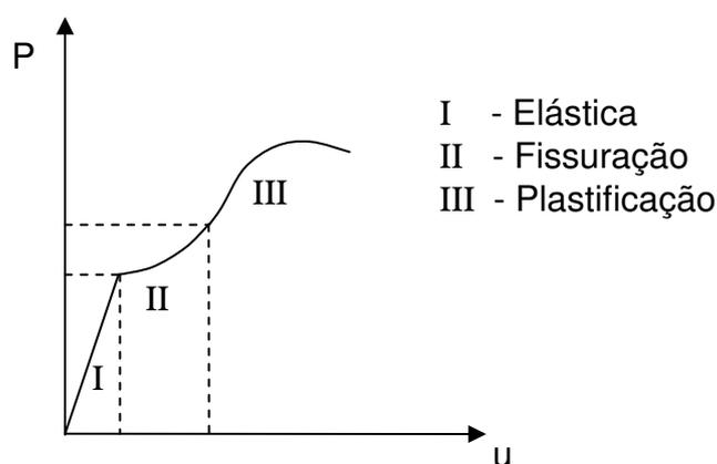
Figura 4.1 – Diagrama carga-deslocamento típico para peças fletidas de concreto armado
