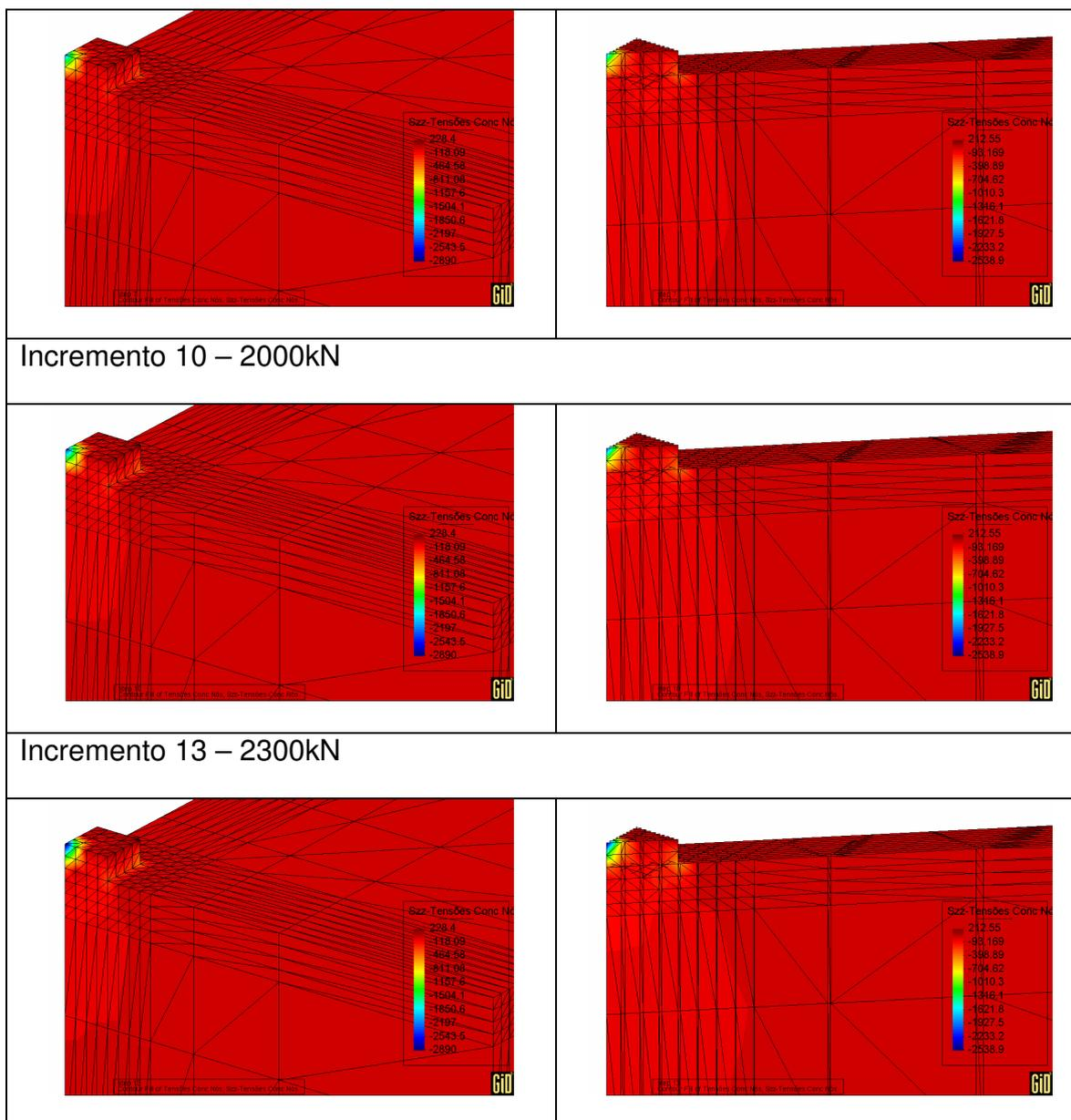
Figura 6.5 – Configuração 1 – Distribuição das tensões normais verticais.
