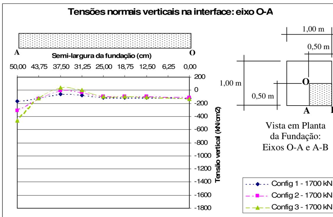
Figura 6.21 – Tensões normais verticais no eixo O-A: Carga 1700 kN/cm<sup>2</sup>.
