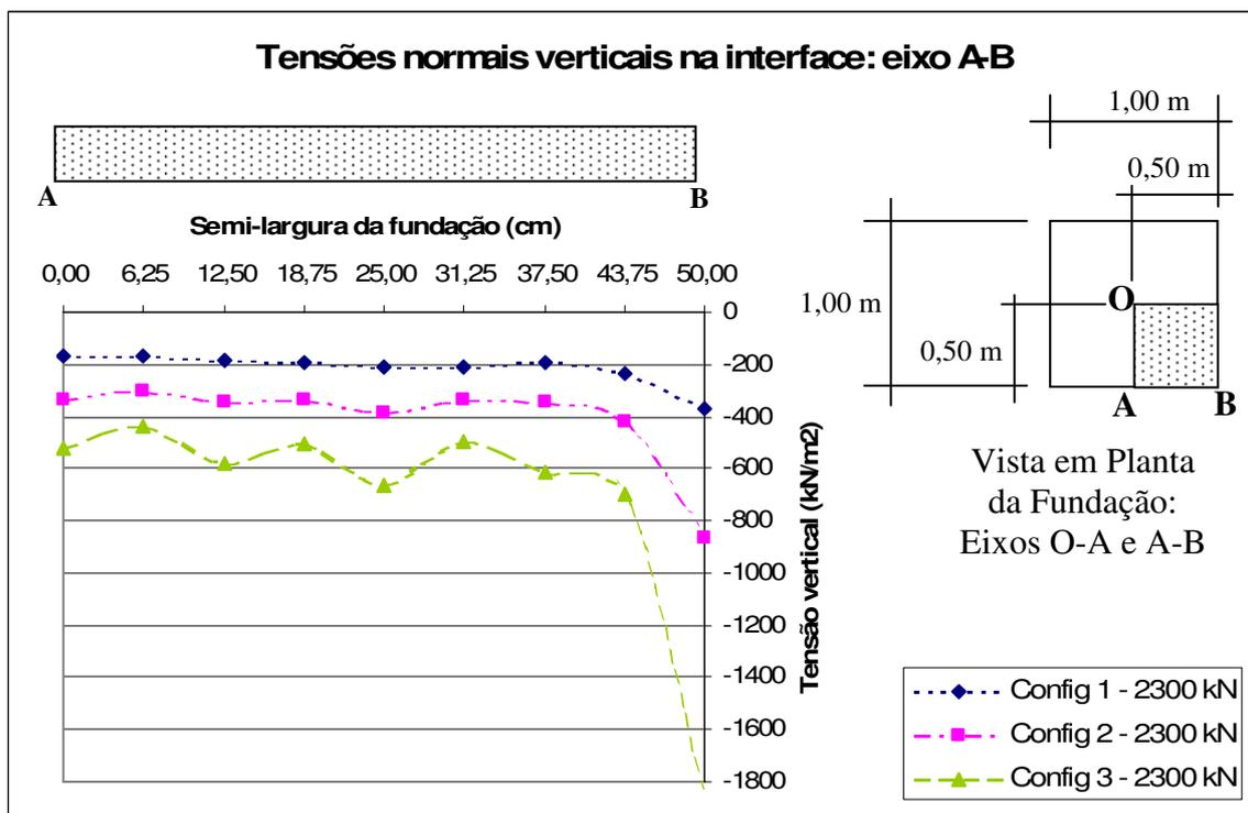
Figura 6.26 – Tensões normais verticais no eixo A-B: Carga 2300 kN/cm<sup>2</sup>.
