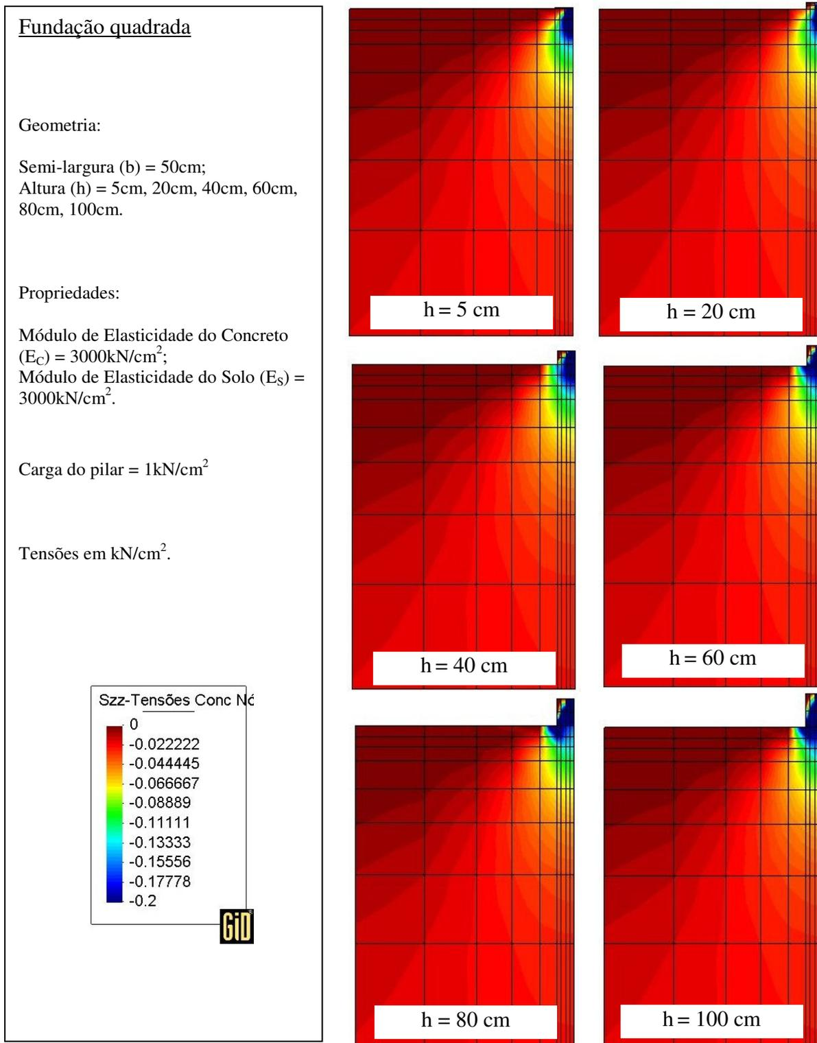
Figura 5.9 – Fundações de diferentes alturas (rigidezes) em solo rígido –
