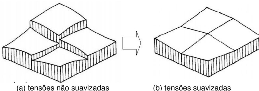
Figura C.1 – Tensões nodais suavizadas e não-suavizadas
