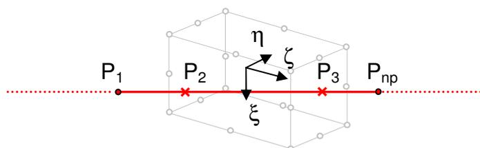
Figura 2.7 – Curva que passa pelos pontos de definição da barra de armadura
