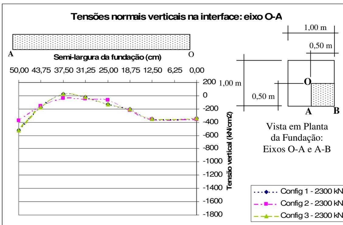
Figura 6.23 – Tensões normais verticais no eixo O-A: Carga 2300 kN/cm<sup>2</sup>.
