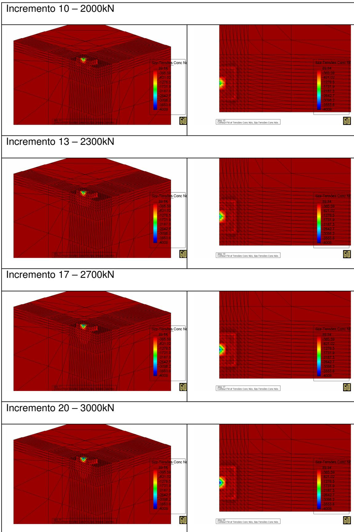
Figura 6.33 – Distribuição das tensões normais verticais
