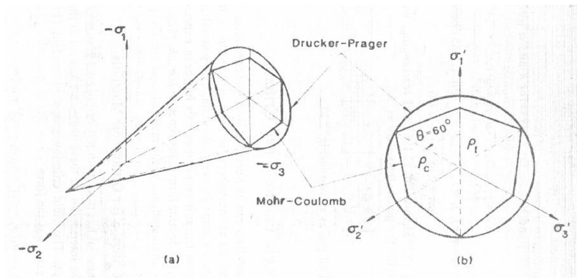
Figura 4.9 – Superfícies de ruptura de Mohr-Coulomb e Drucker-Prager
