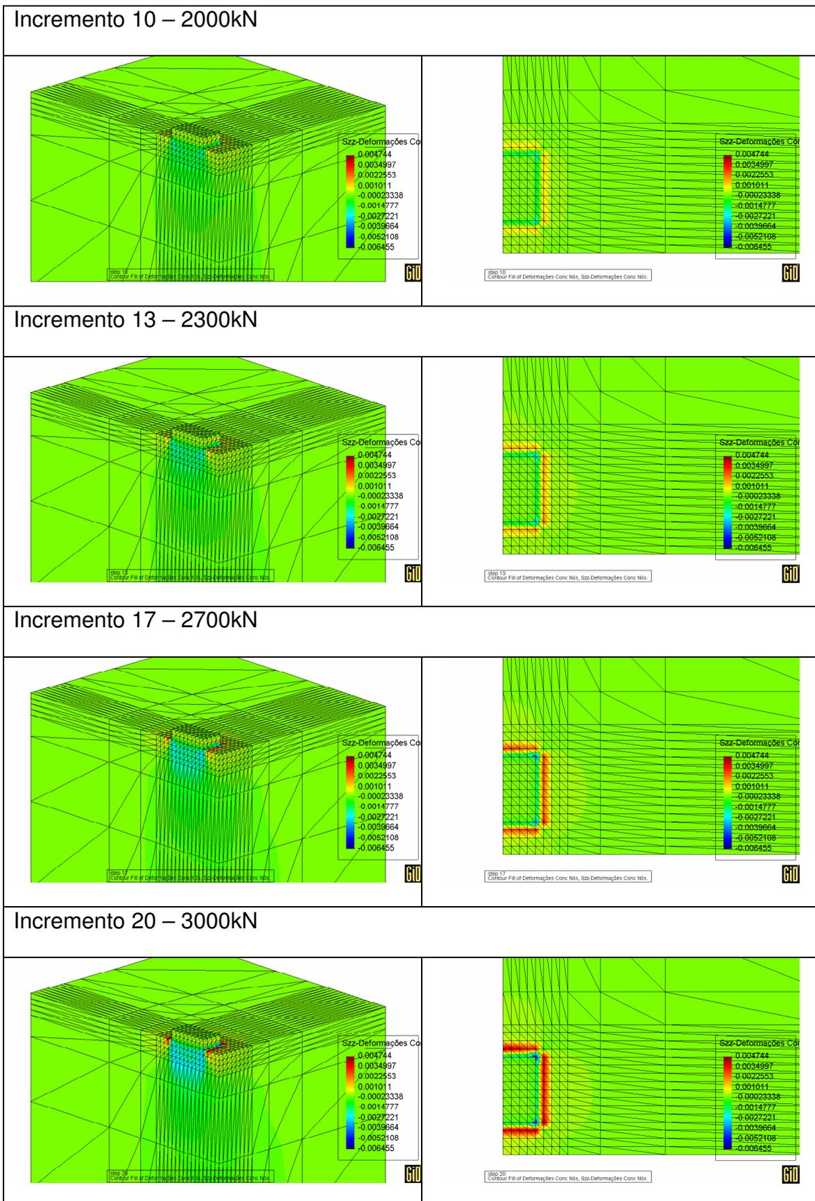
Figura 6.35 – Distribuição das deformações específicas normais verticais
