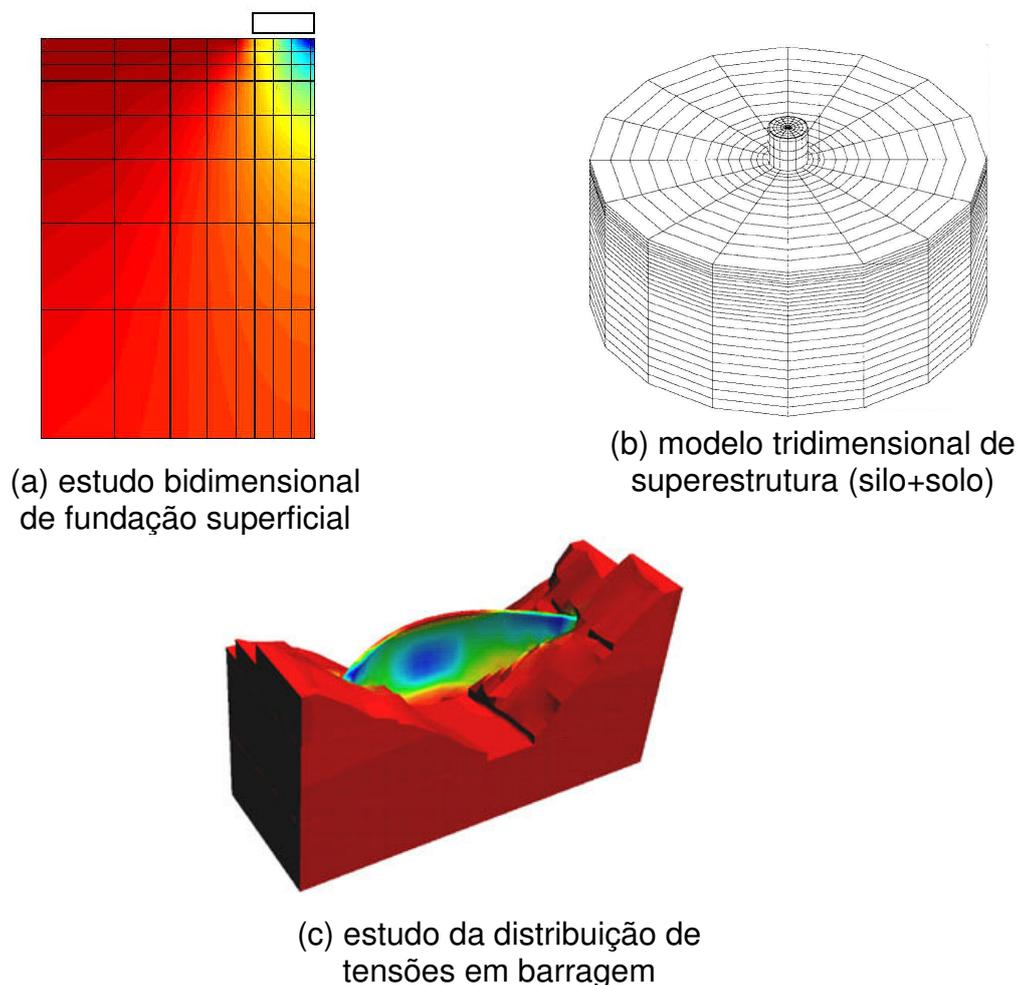
Figura 1.1 – Exemplos de modelos para estudo da interação solo-estrutura
