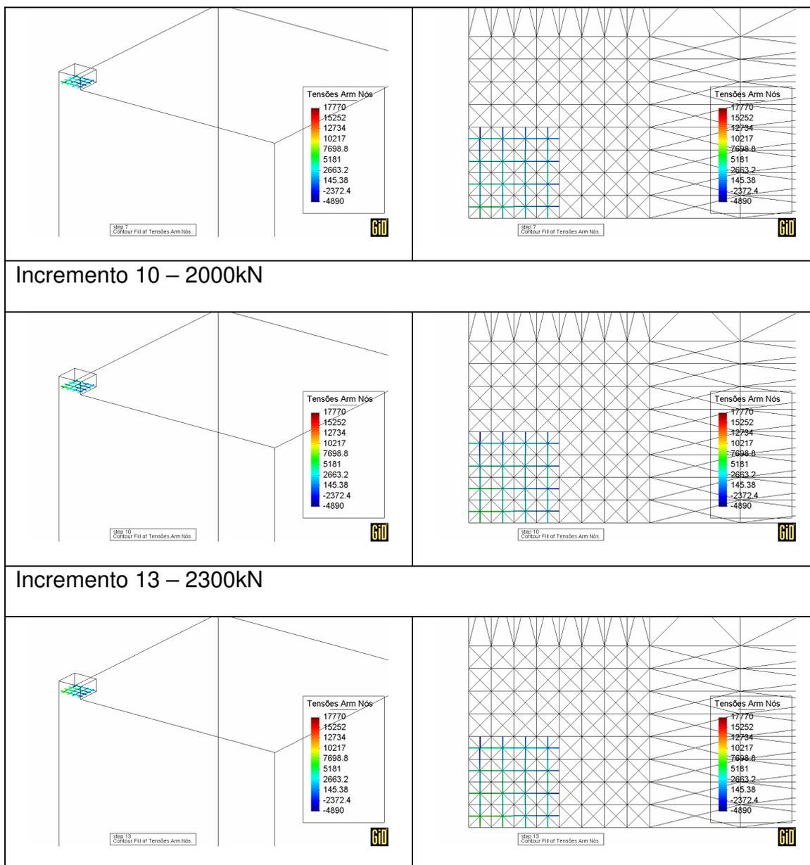
Figura 6.17 – Configuração 3 – Distribuição de tensões na armadura
