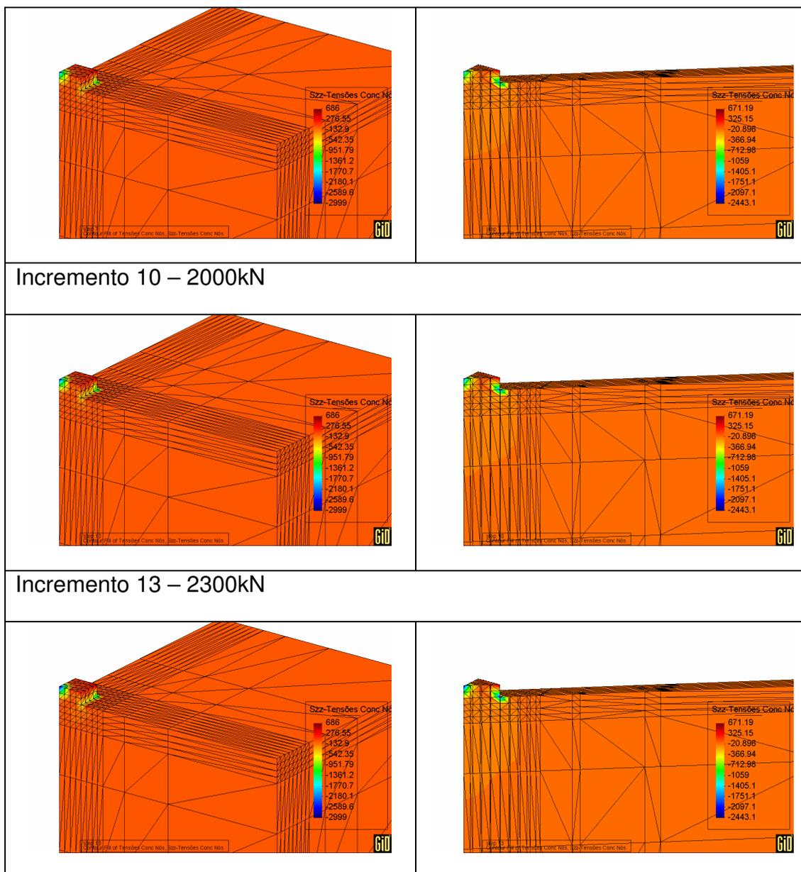
Figura 6.15 – Configuração 3 – Distribuição de tensões normais verticais
