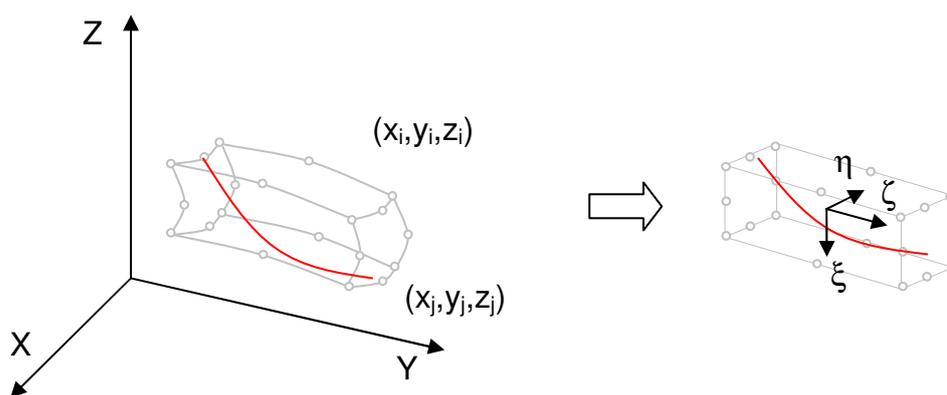
Figura 2.5 – Coordenadas naturais da barra de armadura
