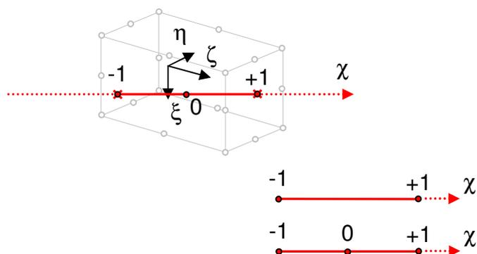
Figura 2.12 – Adição de ponto intermediário no segmento de armadura
