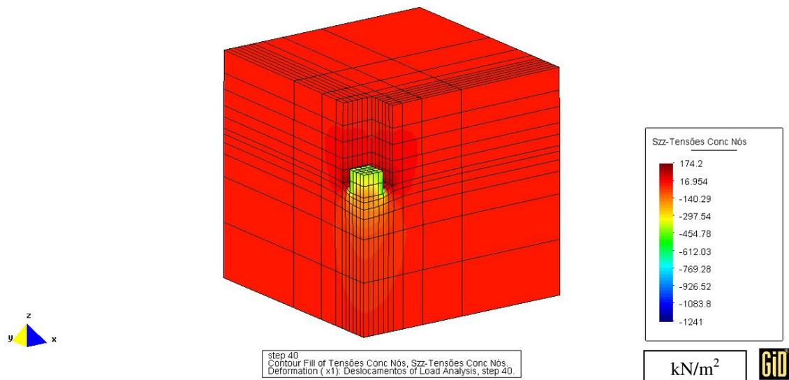
Figura 5.15 – Tensões normais verticais para o estágio final de carga.
