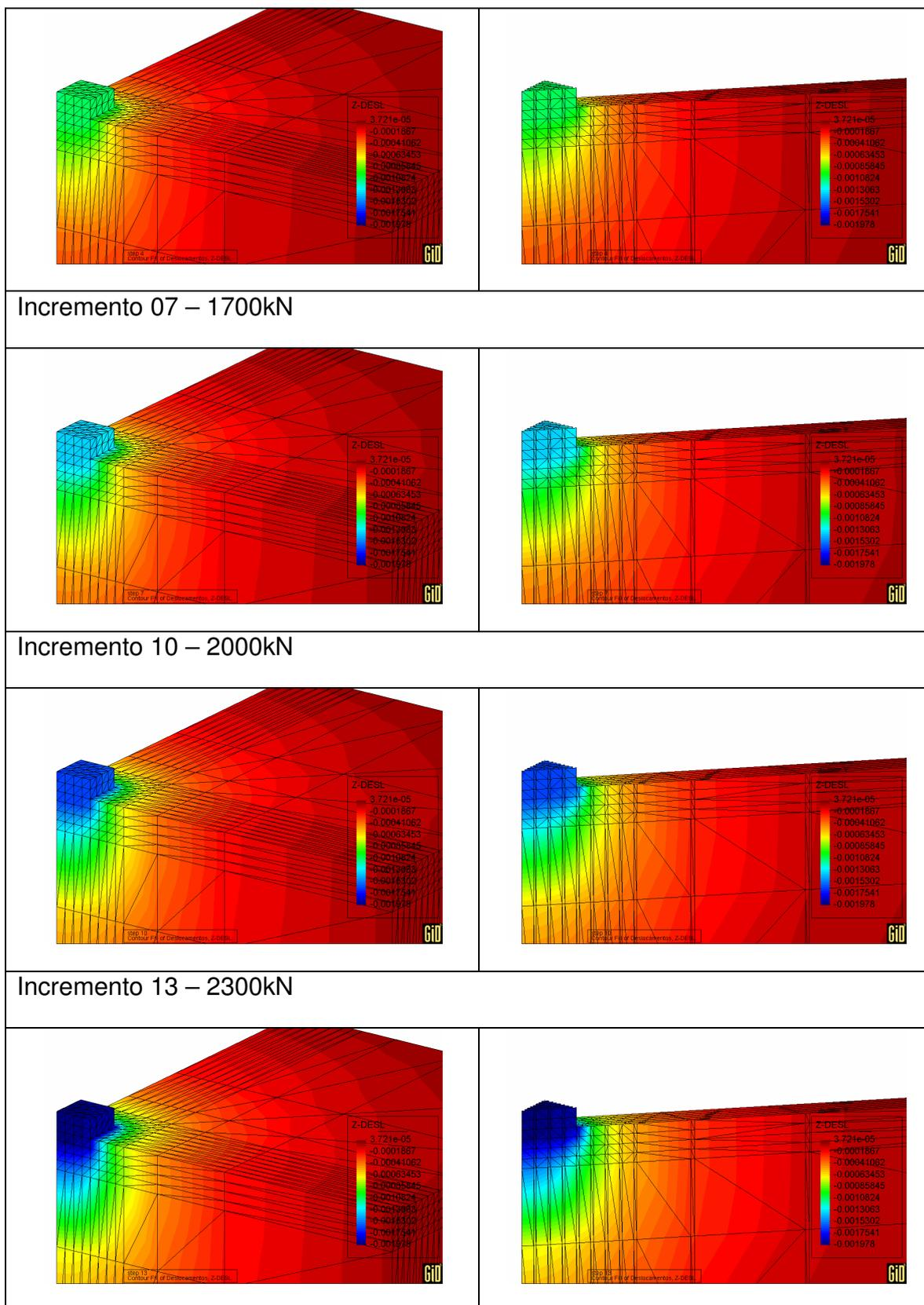
Figura 6.9 – Configuração 2 – Distribuição dos deslocamentos verticais.
