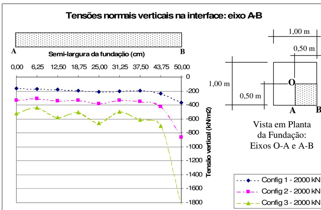
Figura 6.25 – Tensões normais verticais no eixo A-B: Carga 2000 kN/cm<sup>2</sup>.
