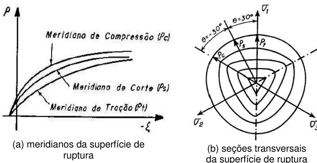
Figura 4.3 – Superfície de ruptura de Ottosen
