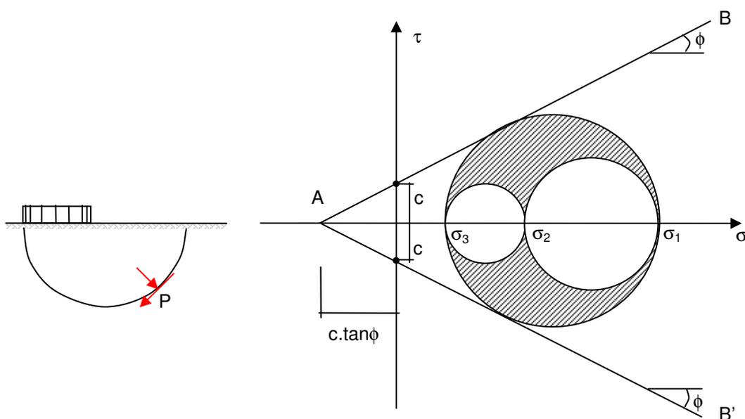
Figura 4.8 – Ilustração do critério de ruptura de Mohr-Coulomb
