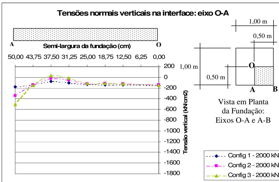
Figura 6.22 – Tensões normais verticais no eixo O-A: Carga 2000 kN/cm<sup>2</sup>.
