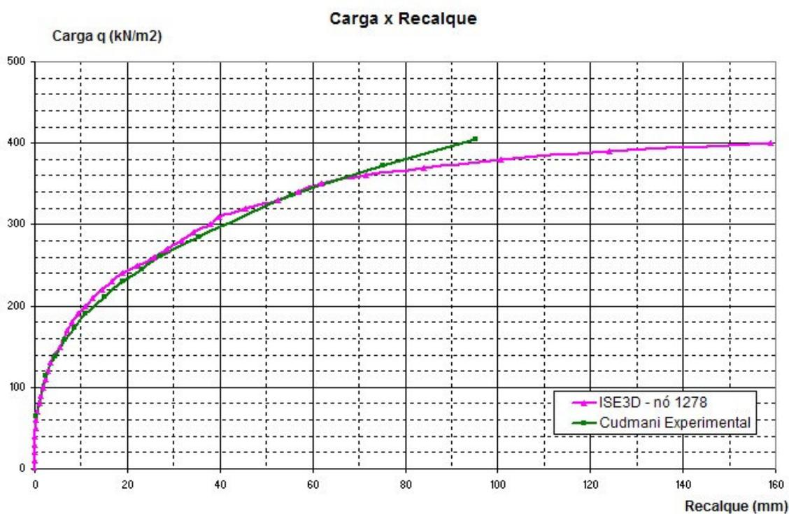
Figura 5.16 – Comparação dos resultados em prova de carga em sapata assente sobre solo residual do programa ISE3D com os resultados obtidos por Cudmani (1994).
