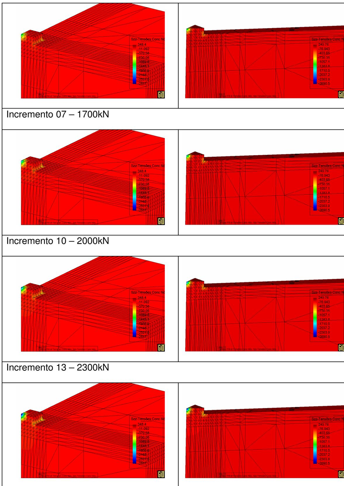
Figura 6.10 – Configuração 2 – Distribuição das tensões normais verticais.
