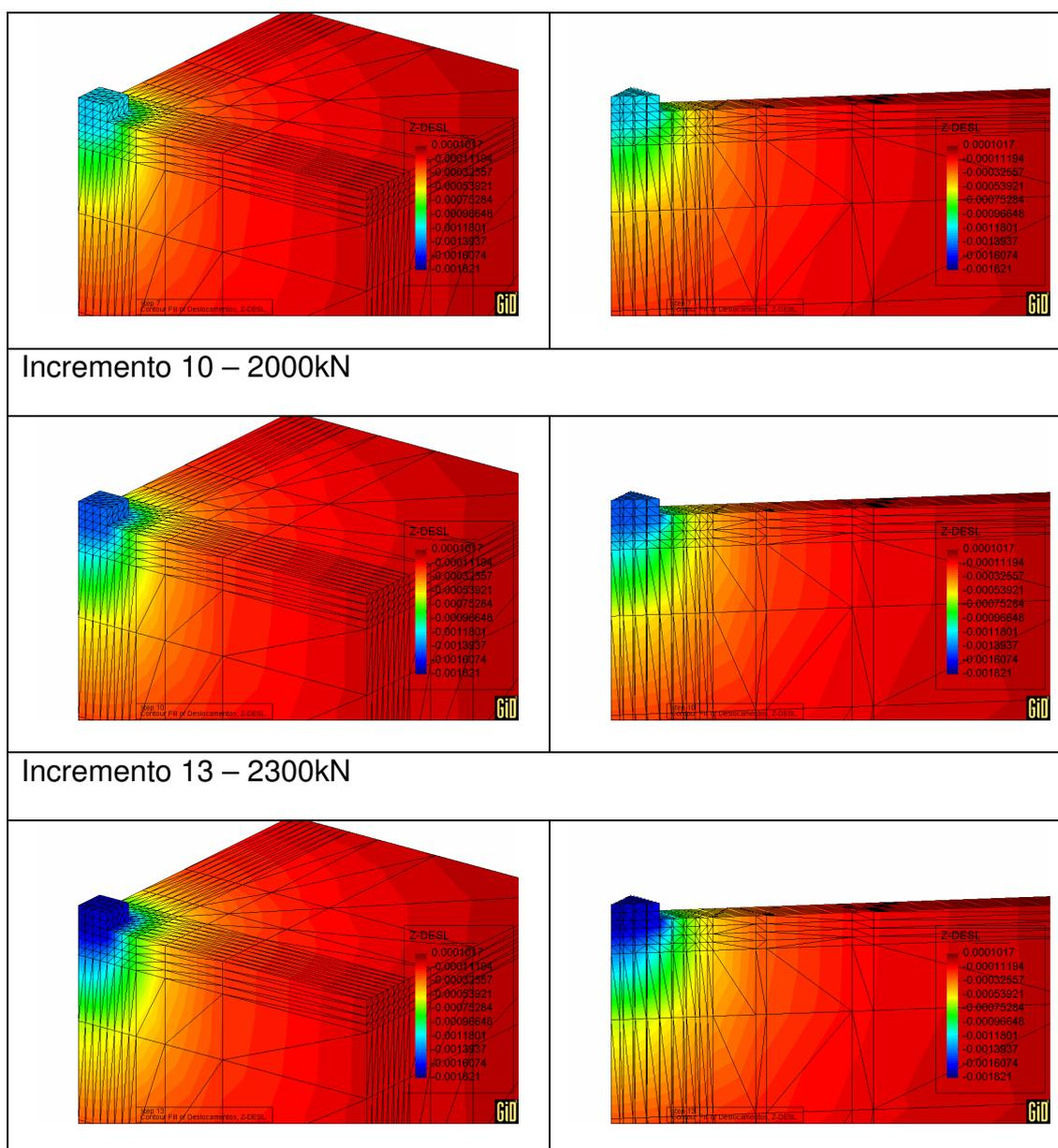
Figura 6.14 – Configuração 3 – Distribuição dos deslocamentos verticais
