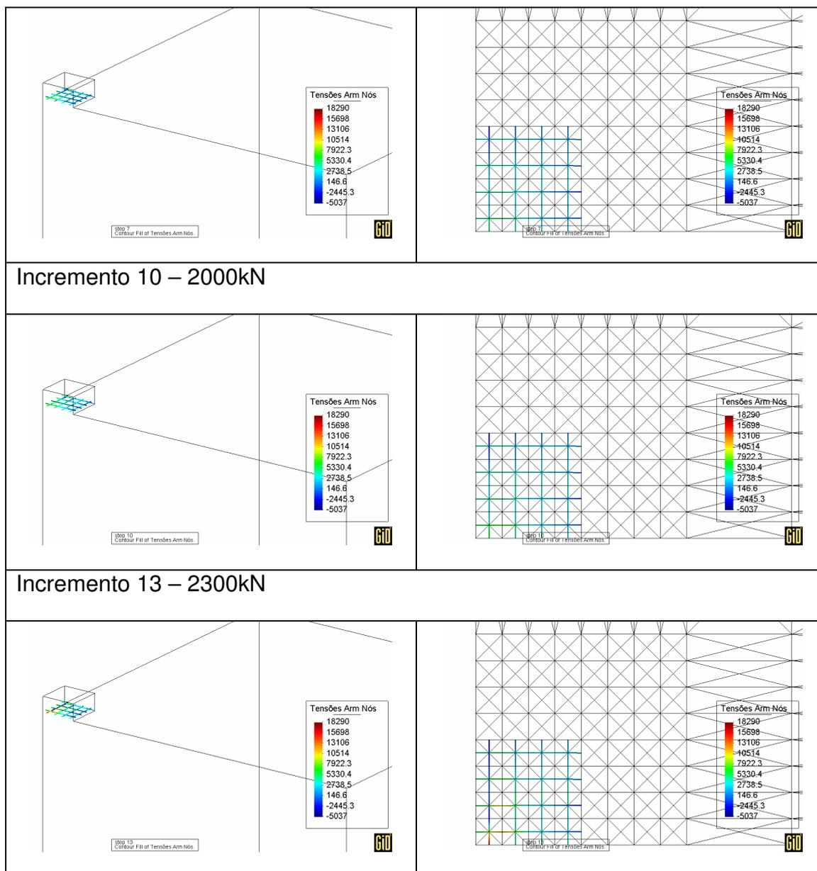
Figura 6.12 – Configuração 2 – Distribuição das tensões na armadura.
