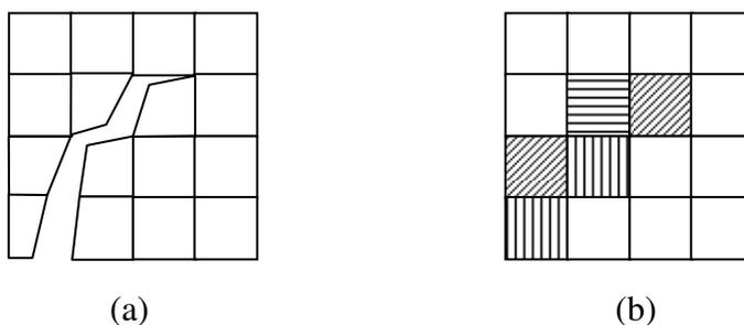
Figura 4.4 – (a) Fissuras discretas; (b) Fissuras distribuídas
