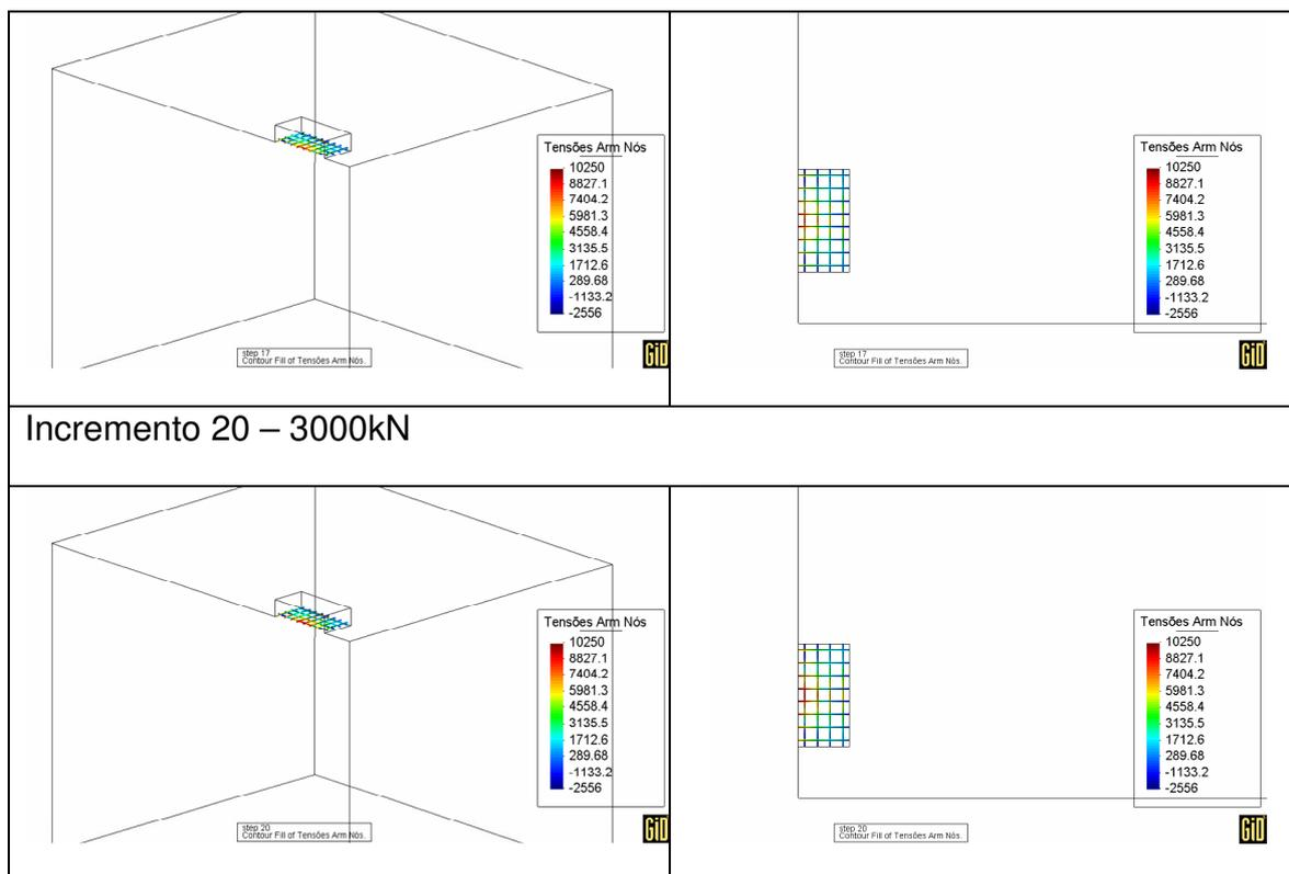
Figura 6.36 – Distribuição de tensões na armadura
