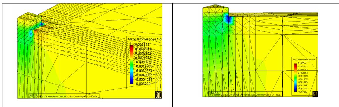
Figura 6.6 – Configuração 1 – Distribuição das deformações específicas normais verticais.
