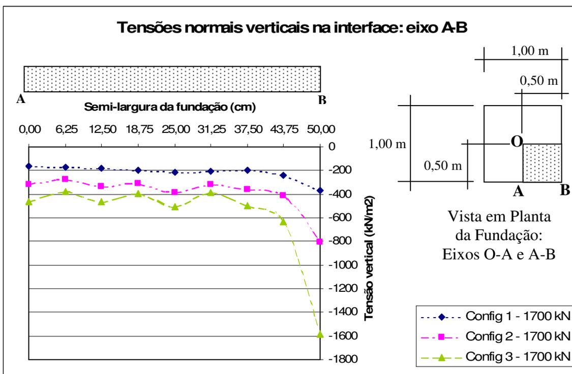
Figura 6.24 – Tensões normais verticais no eixo A-B: Carga 1700 kN/cm<sup>2</sup>.
