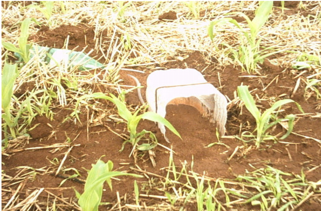
Apêndice 8. Coletor com solo erodido após a 1ª chuva.
