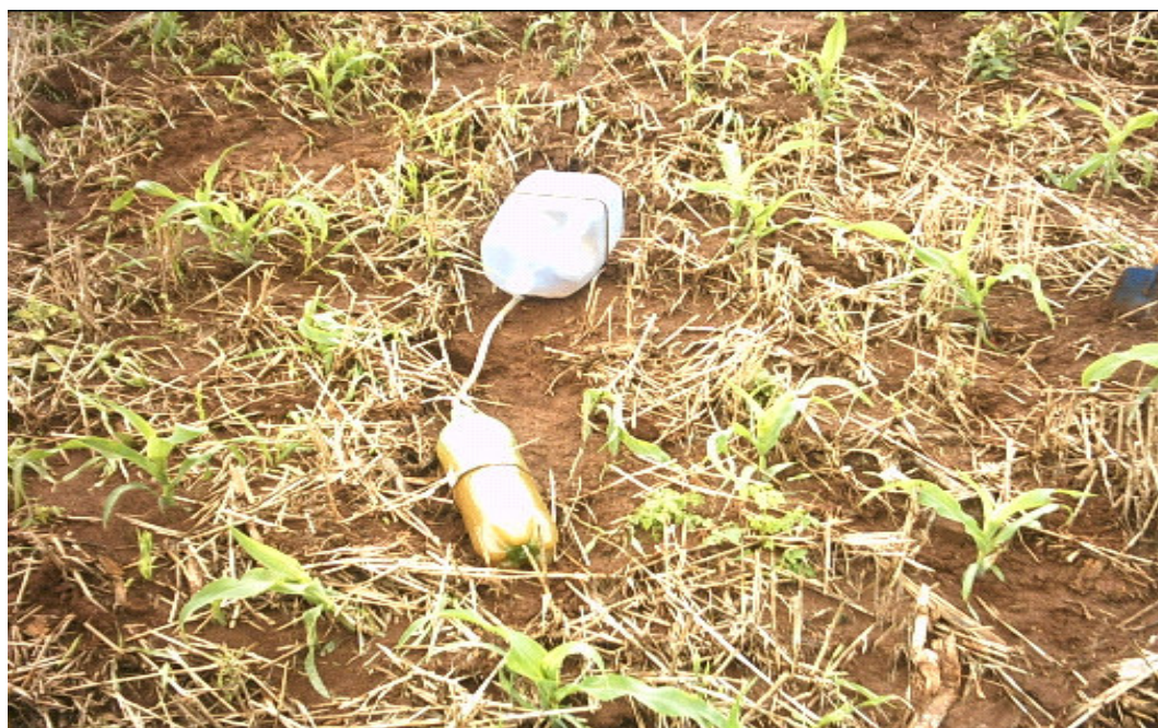
Apêndice 7. Coletor instalado na área em estudo para captar a água e solo perdidos por escoamento superficial após as duas primeiras chuvas após a aplicação dos herbicidas atrazina e simazina.
