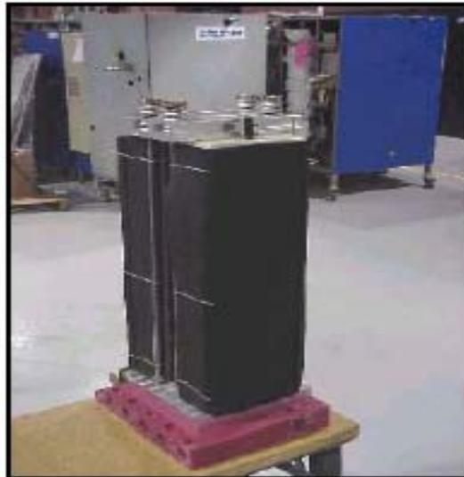
Figura 12: Geração de eletricidade – usa hidrogênio reformado para produzir eletricidade (corrente DC).
