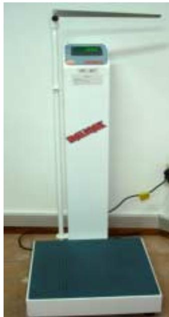
Figura 10 – Balança digital e altímetro (dados do autor)
