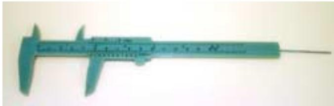
Figura 12 – Paquímetro (dados do autor)
