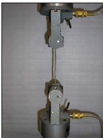
Figura A.1 Esquema de teste de tração com pellet de ATP resultante da primeira extrusão.
