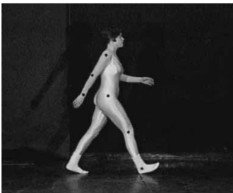
Figura 2.1 - Ensaio fotogramétrico para descrição do caminhar humano [53].
