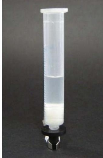
Figura 3 – Coluna de imunoafinidade baseada em imunossuporte sílica-hidrazida-IgG empregando AcM IgG anti-OTA.1.
