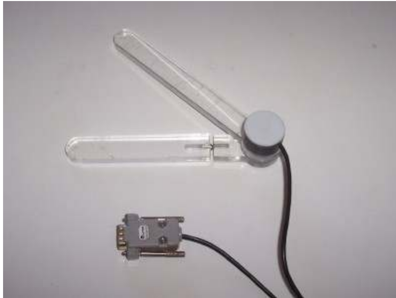
Figura 20 - Goniômetro utilizado para a captação dos ângulos da articulação do cotovelo através do eletromiógrafo.
