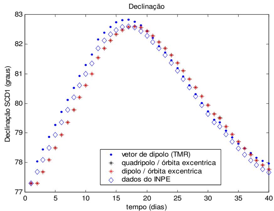
**Figura 7:** Declinação do eixo de rotação para 40 dias (SCD1) com modelos de quadrípolo, dipolo e modelo de vetor de dipolo, órbita elíptica.
