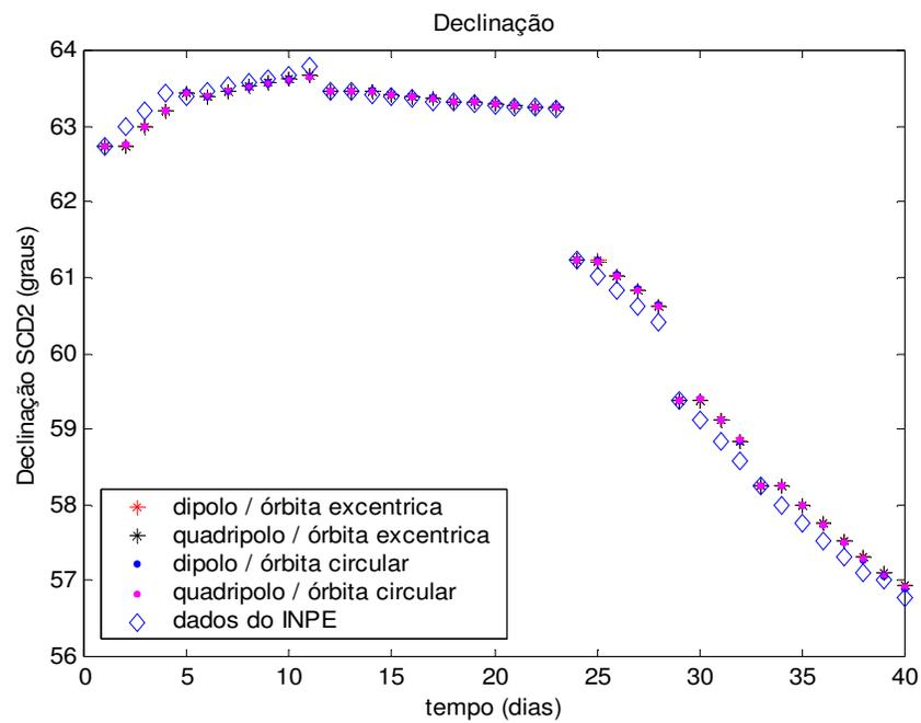
**Figura 23:** Declinação do eixo de rotação para 40 dias (SCD2) com modelos de quadripolo e dipolo, órbitas circular e elíptica.
