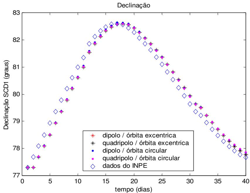
**Figura 5:** Declinação do eixo de rotação para 40 dias (SCD1) com modelos de quadripolo e dipolo, órbitas circular e elíptica.
