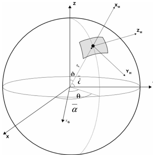
**Figura 3** – Sistema Horizontal Local (O'X<sub>H</sub>Y<sub>H</sub>Z<sub>H</sub>), Sistema do Satélite (Oxyz), Co-latitude ( $\phi$ ), Longitude ( $\theta$ ), Declinação ( $\bar{\delta}$ ), Ascensão reta ( $\bar{\alpha}$ ) do vetor posição do satélite.
