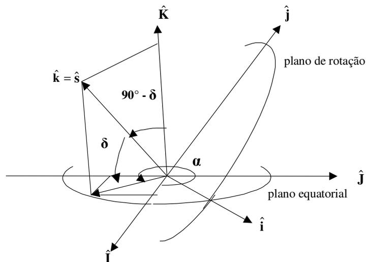
**Figura 1** – Sistema Equatorial  $(\hat{I}, \hat{J}, \hat{K})$ , Sistema do Satélite  $(\hat{i}, \hat{j}, \hat{k})$ , orientação do eixo de rotação  $(\hat{s})$ , ascensão reta  $(\alpha)$  e declinação  $(\delta)$  do eixo de rotação.
